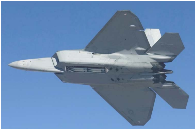
Kuva 1. F-22A Raptorin sisäinen asekuilu [111].
