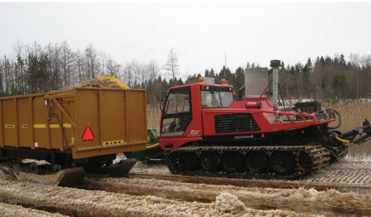
Ruoko korjattiin kaksoissilppuri-rinnekone –yhdistelmällä. Rinnekoneilla ei ollut kulkuvaikeuksia pehmeäpohjaisessa ruovikossa. Korjuunopeus oli noin 4 ha/päivä.
