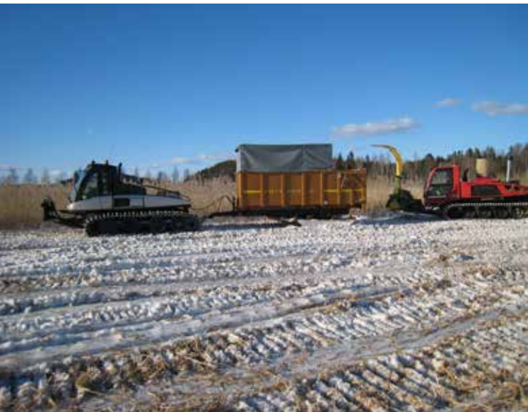
Viurilan rannan talviruo'on korjuussa käytettiin uudenlaisia telaketjuilla varustettuja rinnekoneita. Etummainen rinnetamppari veti perässään isoa peräkärä, johon perässä kulkeva tamppari syötti leikatun ja silputun ruokomassan. Kuva: Pasi Salmi
