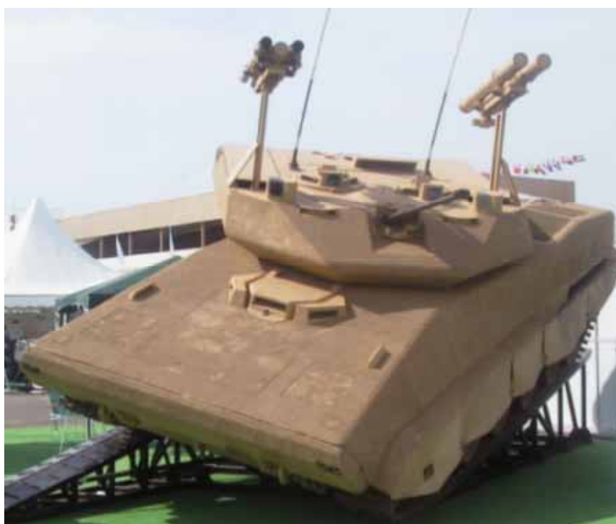
Kuva 255: Valkovenäläisen Minotor Servicen 2T Stalker tiedusteluajoneuvossa on kiinnitetty erityistä huomiota tutka-, infrapuna- ja visuaalisen herätteen minimoimiseen. Tutka- ja infrapunasuojaus on saavutettu muotoilulla, ilmanotto- ja poistoaukkojen sijoittamisella rungon takaosaan ja päällystämällä runko etu- ja yläsektoreista sekä torni noin 4 - 5 mm paksulla tutkasäteilyä vaimentavalla materiaalilla. Stalkerin häiveominaisuudet perustuvat lähinnä rungon muotoiluun ja ilmanotto- ja poistoaukkojen sijoitteluun.
