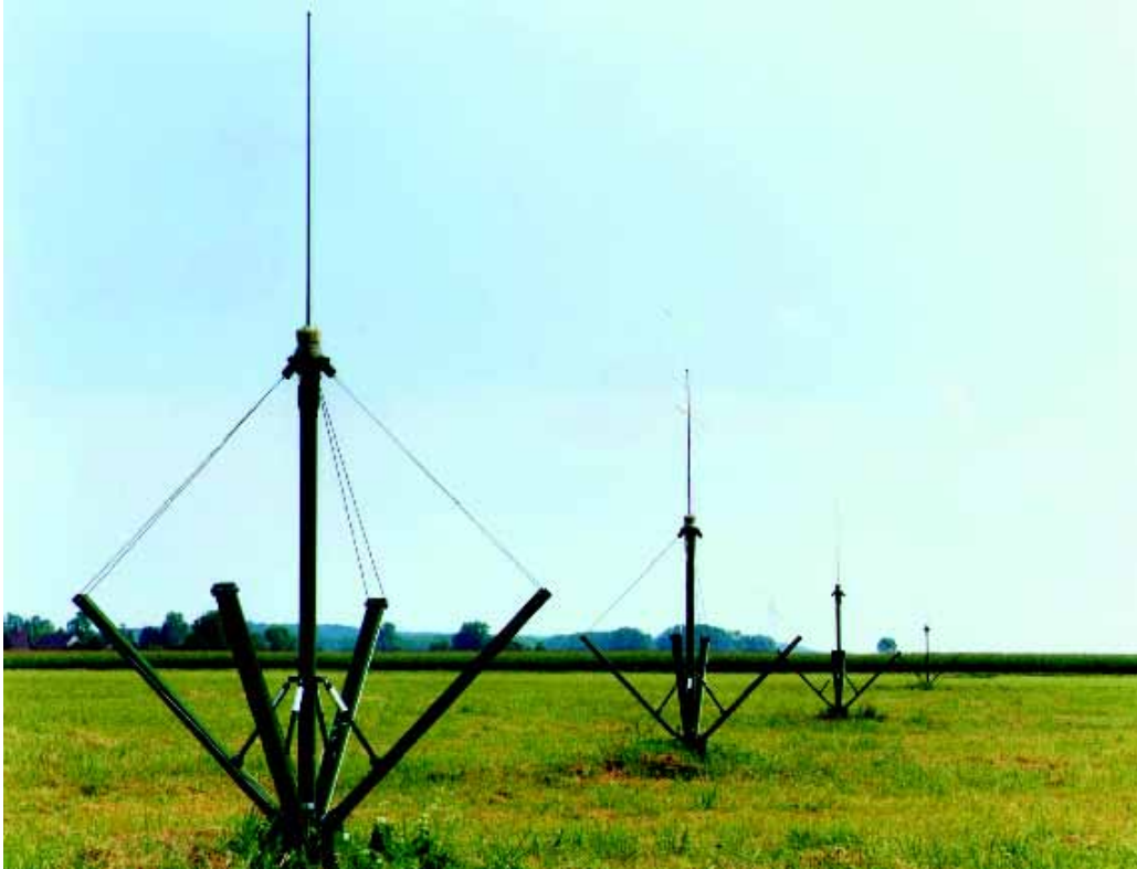
Kuva 218: SSL-paikantaminen HF-taajuuksilla edellyttää laajaa antenniryhmää, joka kykenee mittaamaan saapuvan aallon atsimuutin lisäksi sen elevaation. Kuvan ristikehä-antenneista koostuva antenniryhmä on yksi mahdollisuus HF-lähetteen tiedusteleseen. [EADS Ewation]
