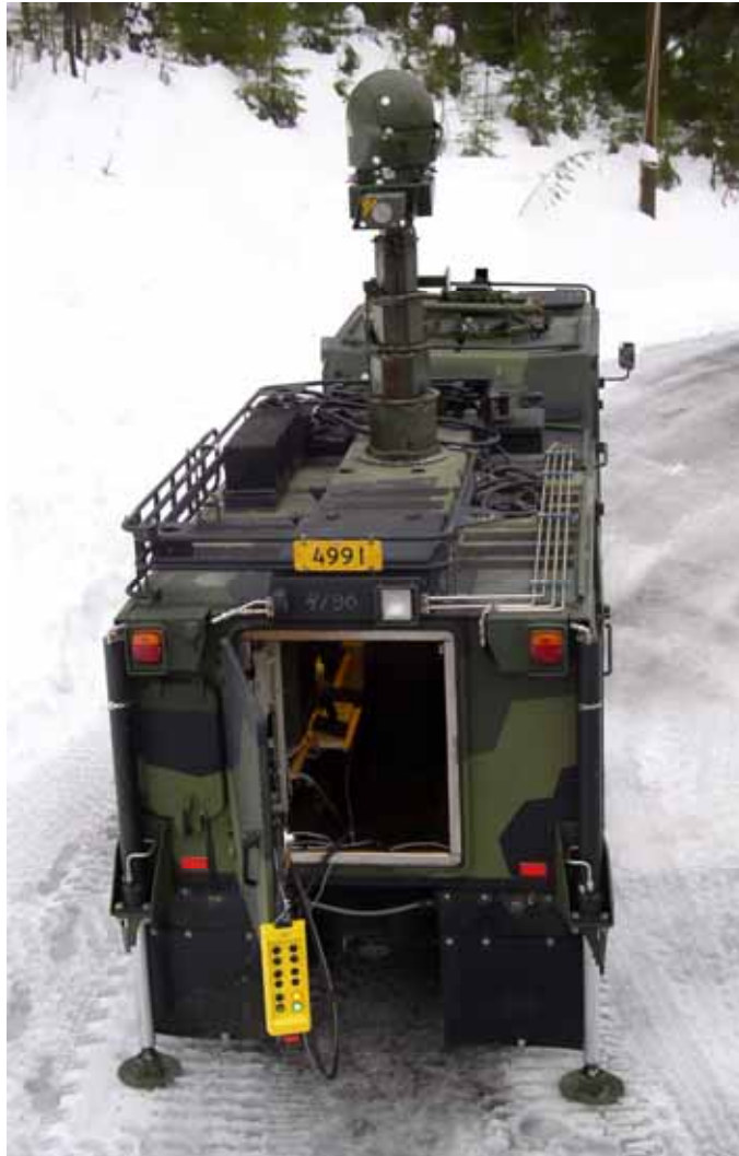
Kuva 229: Maatkotka-kaukotähystysjärjestelmään on asennettu televisio- ja lämpökameran sekä laseretäisyysmittarin sisältävä sensoripallo hydraulisesti nostettavan teleskooppimaston päälle. Telakuorma-autoalusta tarjoaa hyvän liikkuvuuden missä tahansa maastossa.
