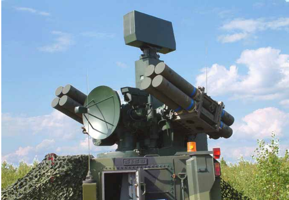
Kuva 280: Ranskalainen Crotale-ilmatorjuntaohjusjärjestelmä asennettuna suomalaiseen Patrian panssariajoneuvoon. [SA-kuva]
