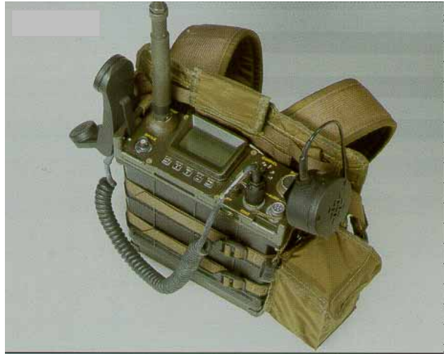
Kuva 97: Tadiranin PRC-6020 HF-kenttäradio tärkeimpine ominaisuuksineen. [SA-kuva]
