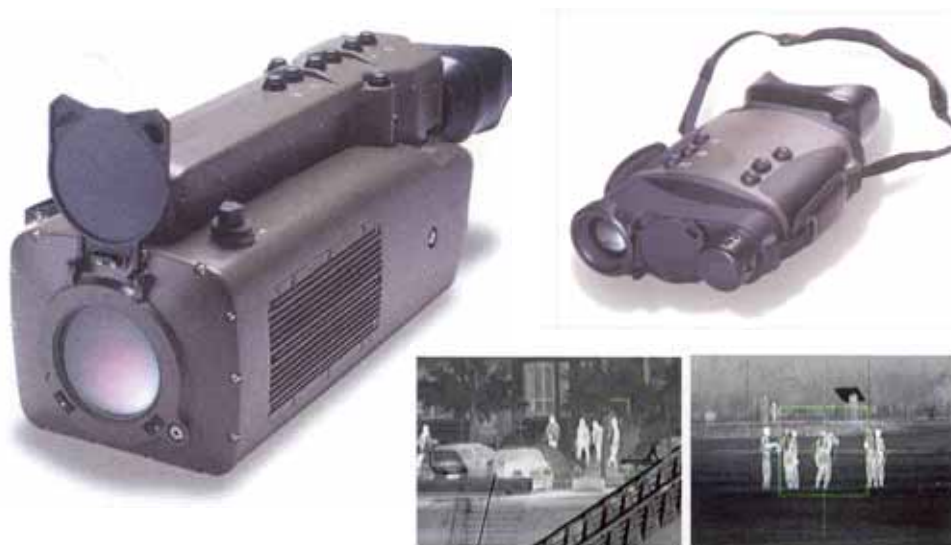
Kuva 232: Kaksi ranskalaisen Sagemin MATIS-lämpökameraa. Valmistaja lupaa järjestelmän havaitsevan taistelilijan 7,5 km ja ajoneuvon 9 km etäisyydeltä sekä tunnistavan ne 2 ja 3,5 km etäisyyksiltä. [Sagem]
