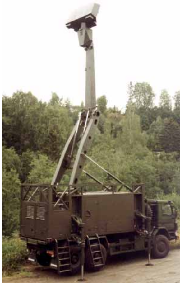
Kuva 133: Ericssonin AMB-tutka (Agile Multi Beam) keila vaakatasossa mekaanisesti ja pystytasossa elektronisesti. [Ericsson]
