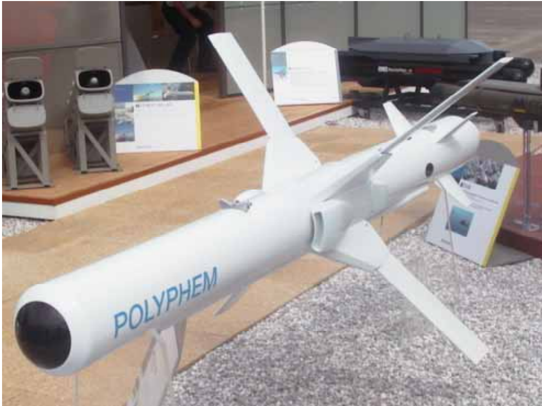
Kuva 273: Valokuituohjattu PolypheM-ohjus. 140 kg painavan ohjuksen kantama on 60 km. Ohjus lentää 120 - 220 m/s nopeudella ja 20-400 m korkeudella inertia- ja GPS-paikantimen avulla haluttuun maalipisteeseen. Vakautetussa hakupäässä on kuvaava PtSi-matriisi-ilmaisin, joka havaitsee maalin 8 km etäisyydeltä. Maalintunnistus 1,5 km etäisyydeltä antaa operaattorille 10 s aikaa valita ja vahvistaa maali. [J. Kosola]
