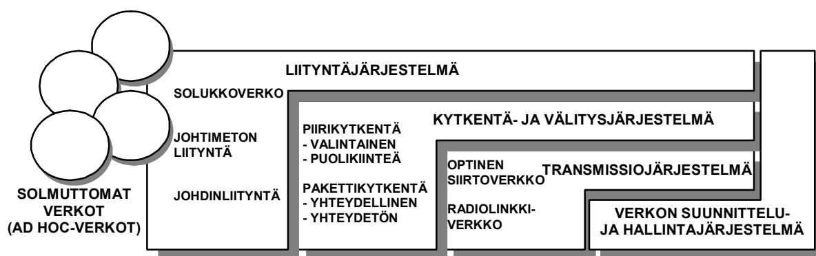
Kuva 66: Esimerkki viestijärjestelmän jakamisesta toiminnallisiin osiin.
