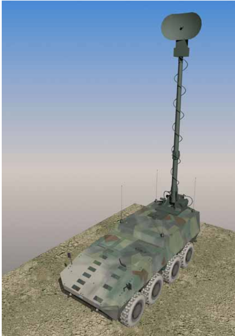
Kuva 201: Tietokoneella luotu kuva tiedustelujärjestelmästä, joka on asennettu suomalaisen Patria Vehicles:n AMV-panssariajoneuvon alustalle. [Patria Vehicles]
