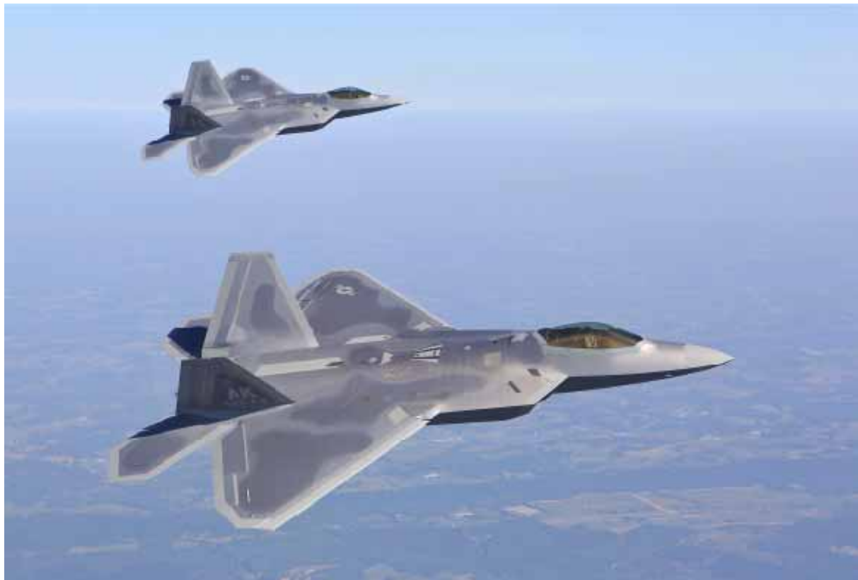
Kuva 253: Ilmaherruushävittäjä F-22 Raptorissa on hyödynnetty häiveteknologista muotoilua. [Lockheed Martin]
