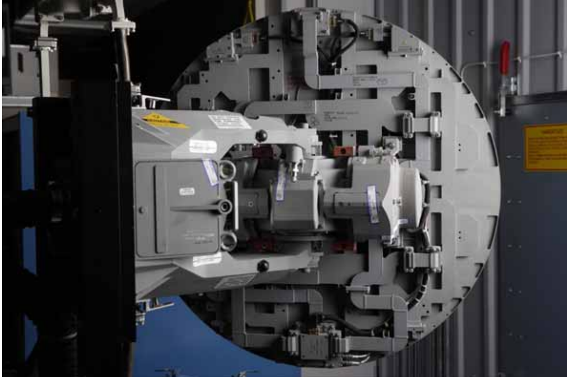
Kuva 190: F-18 Hornetin APG-65 pulssidopplertutkan antennin takaosassa näkyvät antennin kääntökoneisto sekä aaltojohdot. [Patria]
