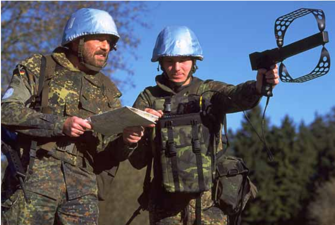
Kuva 215: Kannettavaa hakusuuntimoa voidaan käyttää sekä lähettimien – kuten vihollisen radioiden tai salakuuntelulaitteiden – paikantamiseen, että lähetysten kuunteluun ja signaaliparametrien tallentamiseen. Suuntiminen perustuu pistoolimaisen suunta-antennin kääntelyyn ja signaalin voimakkuuden määrittämiseen. [Rohde & Schwartz]
