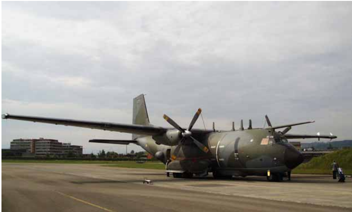
Kuva 264: Ranskan ilmavoimien C160 Gabriel –tiedustelukone. Hercules C-130 kuljetuskoneesta modifioidun tiedustelukoneen tiedusteluvarustus sisältää sekä COMINT-, että ELINT-järjestelmät sekä optisen kuvauslaitteiston. [J. Kosola]
