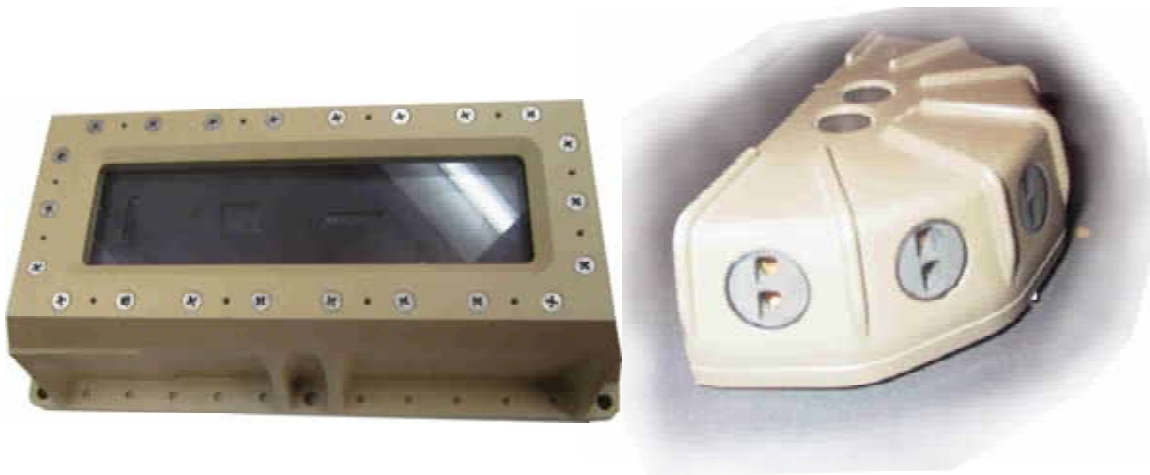
Kuva 328: Kaksi esimerkkiä laservaroittimen sensoriyksiköstä. Vasemmanpuoleinen laite perustuu konseptiin, jossa suojattavaan kohteeseen sijoitetaan useita halpoja detektoreita, ja oikeanpuoleinen ratkaisuun, jossa muutamalla suorituskykyisemmällä vastaanottimella kyetään kattamaan koko suojattava kohde. Kummallakin konseptilla on omat hyvät ja huonot puolensa – optimaalinen ratkaisu riippuu aina tilanteesta. [J. Kosola]
