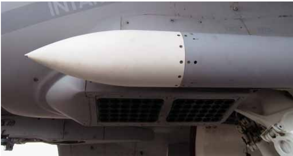
Kuva 341: Sveitsiläisen F-18 Hornetin omasuojaheittimet näkyvissä AMRAAM-ohjuksen kärkikartion takana. [J. Kosola]
