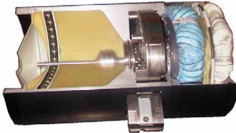
Kuva 285: SMARt sirotteessa vasemmalla millimetriaaltotutka-antenni, johon signaali syötetään ontelopanoksen räjähdysaineen läpi aaltoputkella sirotteen keskellä sijaitsevasta mmW-tutkasta. Kuvassa alhaalla oleva ulkonema on lämpösensori. Sirotteen takaosassa, kuvassa oikealla on laskuvarjo. Tutka-antennin takana olevat kuulat on tarkoitettu elävää massaa ja panssaroimattomia ajoneuvoja vastaan. [J. Kosola]
