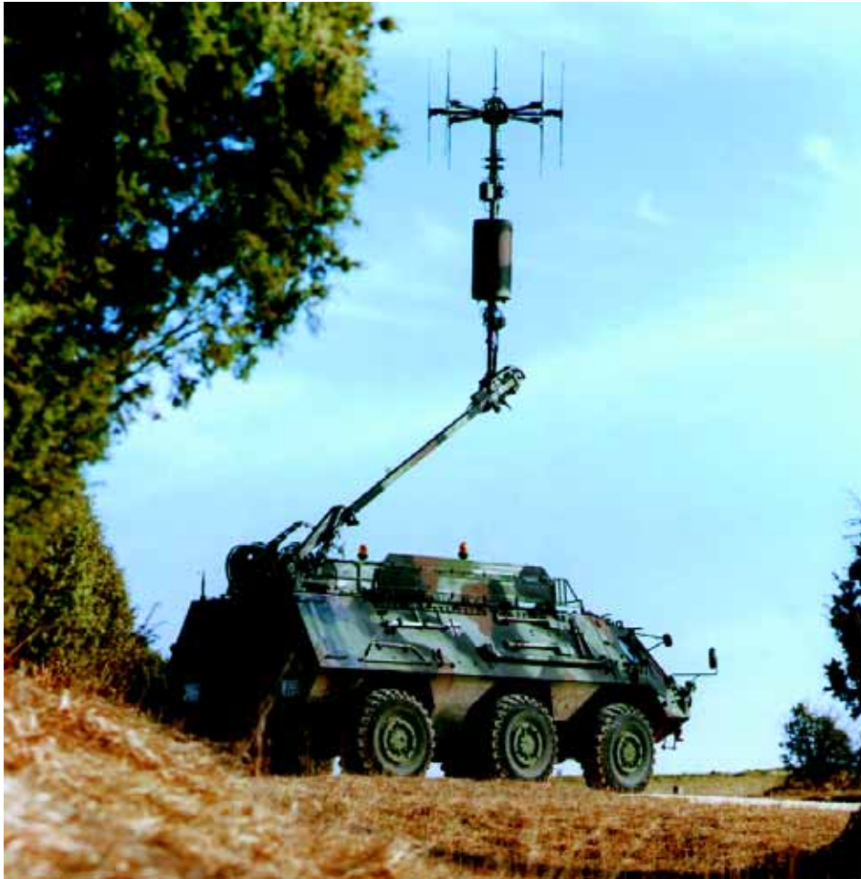
Kuva 214: Kuuntelutiedustelujärjestelmän kapea-aperttuurinen suuntimoasema. [EADS Ewation]
