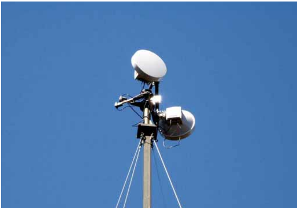
Kuva 99: COTS-radiolinkki soveltuu hyvin sotilaskäyttöön hyvän ympäristönkeston, luotettavuuden, kapean keilan ja hyvän sivukeilatason sekä halvan hinnan vuoksi. Kuvassa kaksi Ericssonin Minilinkkiä sotilaskäytössä. [SA-kuva]
