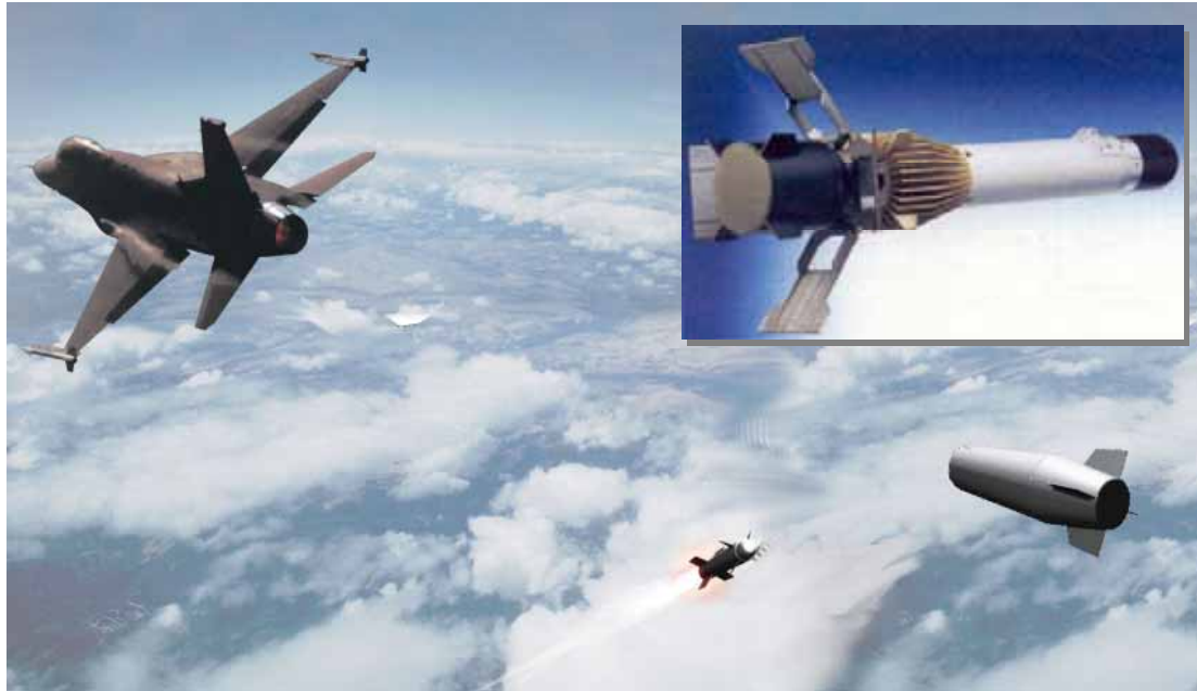
Kuva 344: Perässä vedettävät valemaalit ovat tehokas tapa suojata lentokoneita ja laivoja. Isossa kuvassa Raytheonin ja pienessä DASAn häirintälähtettimet [Raytheon ja Sanders].
