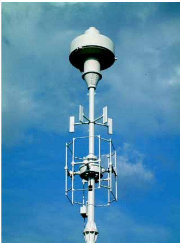
Kuva 199: ELINT- ja ESM-asemien mastoissa korkeataajuisimmat antennit asennetaan yleensä ylimmiksi. Saksalaisen EADS:n valmistama ESM-antenni. [EADS Ewation]
