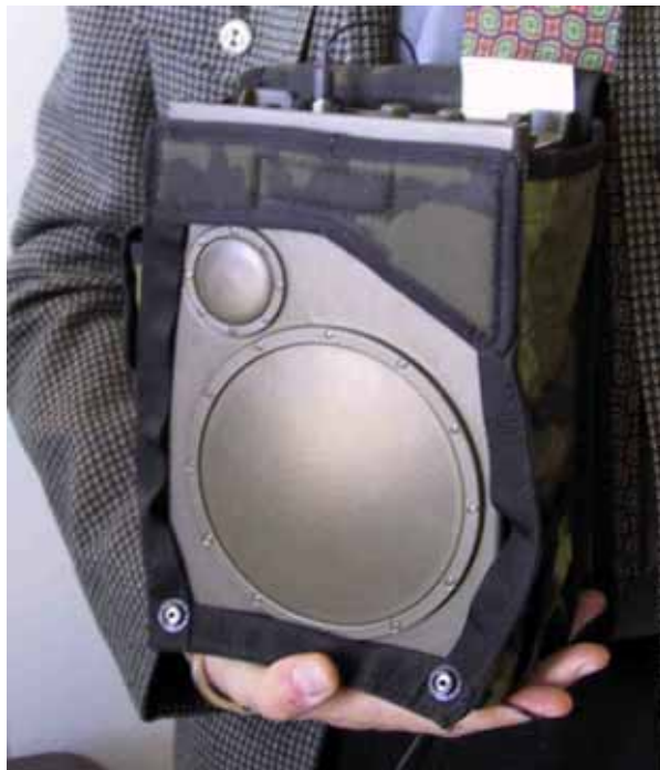
Kuva 324: Esimerkki erikoisjoukkojen käyttöön tarkoitetusta kannettavasta tutkavaroittimesta, jonka avulla kyetään suojaumaan maastonvalvontatutkalta. [J. Kosola]
