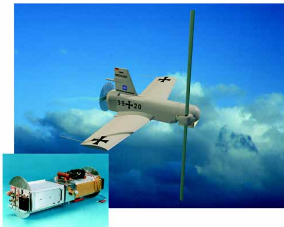
Kuva 295: EADS Ewation suunnittelema lennokki, jonka hyötykuormaksi on mahdollista varustaa joko häirintä- tai tiedustelujärjestelmä. [EADS Ewation]
