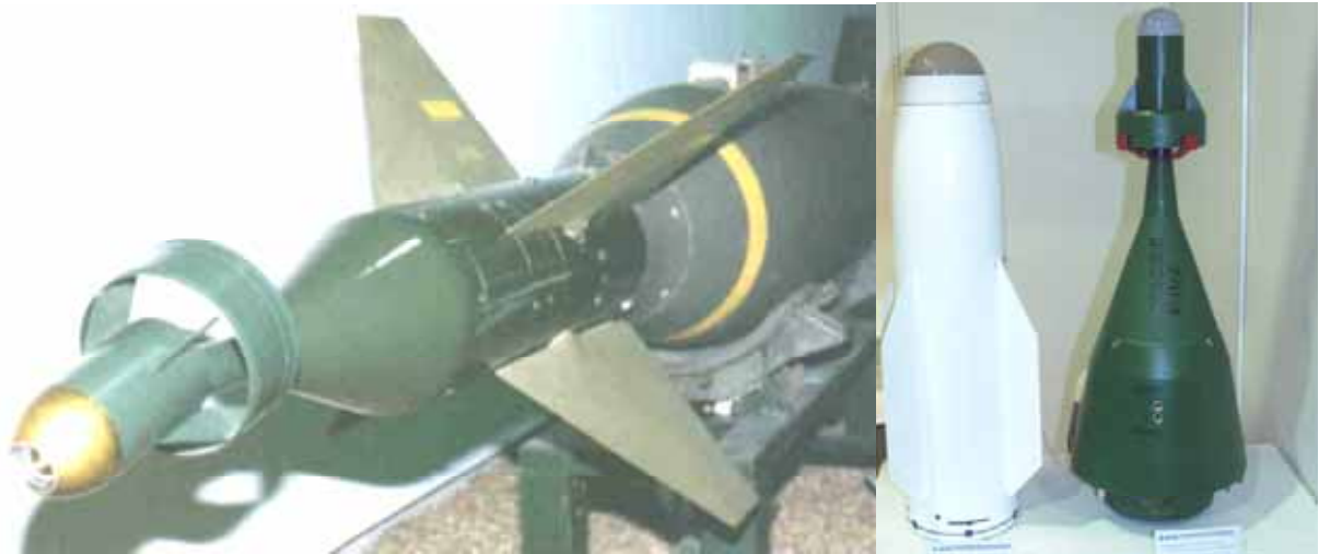
Kuva 288: Vasemmalla amerikkalainen ja oikealla venäläinen laserhakeutuvan pommin hakupää. Oikeanpuoleisen kuvan vasemmanpuoleinen moduuli on venäläinen IR-hakuisen täsmäpommin hakupääyksikkö. [J. Kosola]
