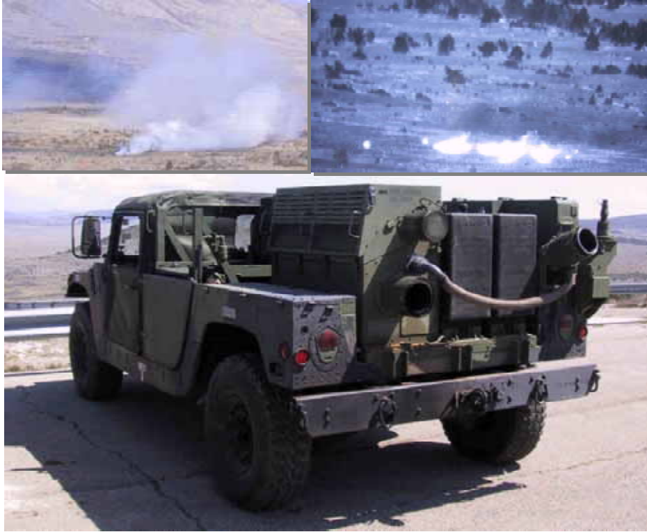
Kuva 343: Kohdesuojaukseen tarkoitettu savutusajoneuvo. Vasemmanpuoleisessa pienoiskuvassa ajoneuvon savutuksen vaikutusta tarkasteltuna paljaalla silmällä ja oikeanpuoleisessa lämpökameralla katsottuna. Kuvasta nähdään selvästi, kuinka lämpökamera näkee suhteellisen vaivattomasti tavallisen savun läpi. [J. Kosola]
