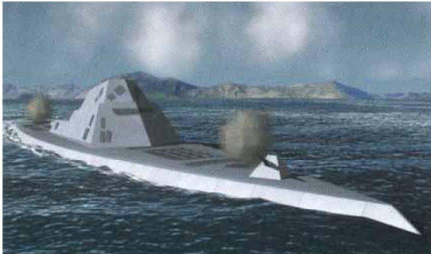
Kuva 256: United Defensen konseptissa kannelle ei ole sijoitettu juuri minkäänlaisia tutkasäteilyä sattumanvaraisesti heijastavia rakenteita ja aluksen kyljet ja kansirakenteet on suunniteltu siten, että sivulta tuleva tutkasäteily heijastuu ylöspäin. [United Defense]
