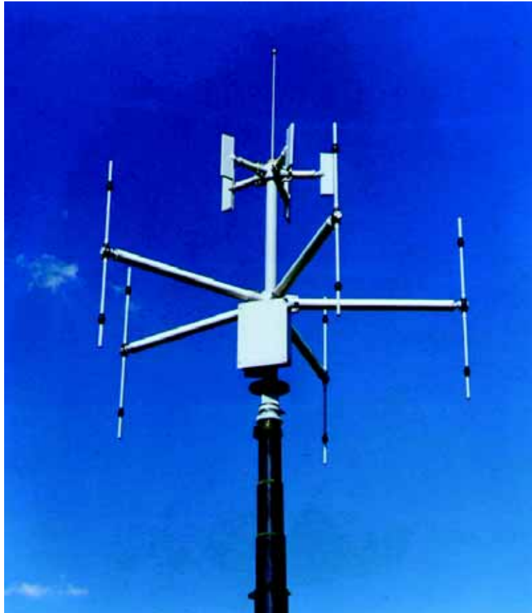
Kuva 217: Mastoon asennettu viisikanavainen interferometrisuuntimo, joka toimii 20 – 1000 MHz:n taajuusalueella. [EADS Ewation]
