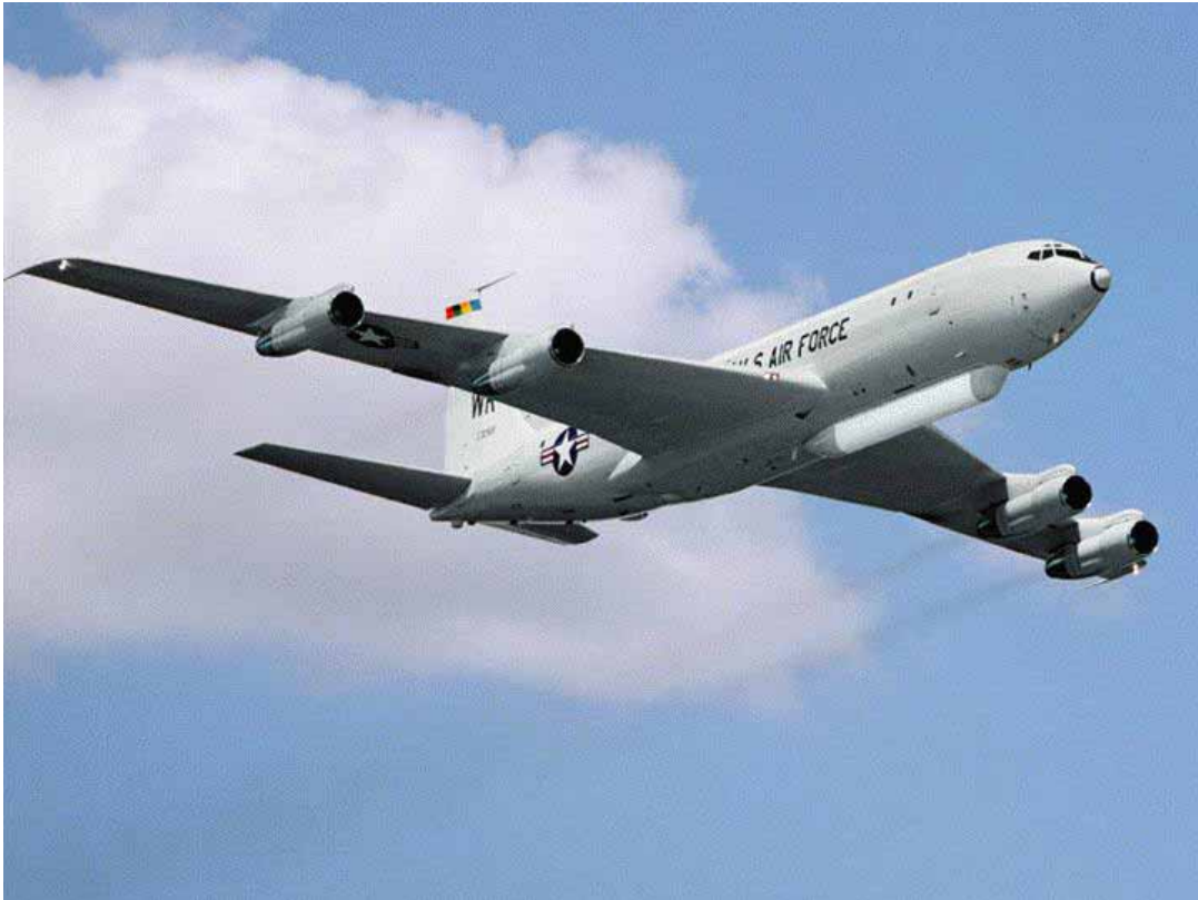
Kuva 170: Amerikkalainen Joint STARS-tutkavalvontakone tuottaa tietoa liikkuvista ja paikallaan olevista maaleista tiedustelu, operatiivisen johtamisen ja maalinsoituksen tarpeisiin. Nokan alapuolella näkyy selvästi 12 metrin radomi, joka suojaa 7,5 metrin pituista vaiheohjattua tutkan antennia. Antennikeila on SAR-moodissa 120 astetta. Tutkan kantamaksi valmistaja ilmoittaa 250 km. [USAF]
