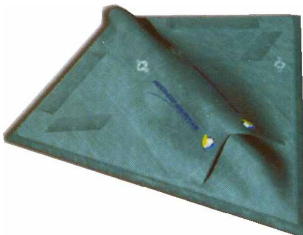
Kuva 257: Leijan kaltaisessa Northrop Grumman'n lennokissa satelliittilinkin radomi peittää ilmanottoaukot alhaalta ja edestä katsottuna. Siiven johto- ja jättöreunat ovat ainoat kulmapinnat ja nekin on voimakkaasti viistetty siten, ettei säteilyä juurikaan heijastu takaisin tulo-suuntaansa. Erillisten korkeus- ja sivuvakaajien tarve on eliminoitu käyttämällä tähän siivekkeitä. [Northrop Grumman]
