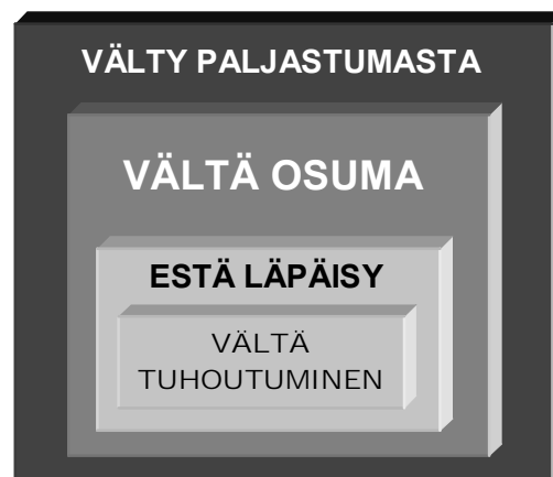
Kuva 317: Omasuojajärjestelmän primäärisenä tehtävänä on osuman välttäminen ja sekundäärisenä tehtävänä aseiden toiminnan häiritseminen siinä määrin, ettei sen taistelulataus kykene läpäisemään kohteen suojapanssaria.
