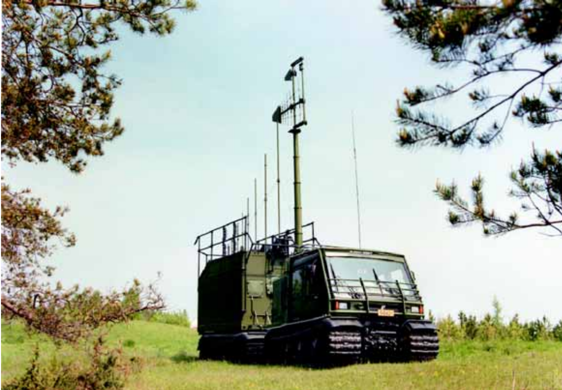
Kuva 297: Norjan armeijan käyttämä HF-V/UHF häirintäjärjestelmä Tor, joka on saanut nimensä viikinkitarujen jumalan Odinin pojan mukaan. Häirintäjärjestelmä on asennettu Suomessa valmistettuun raskaaseen P6 telakuorma-autoon. [EADS Ewation]
