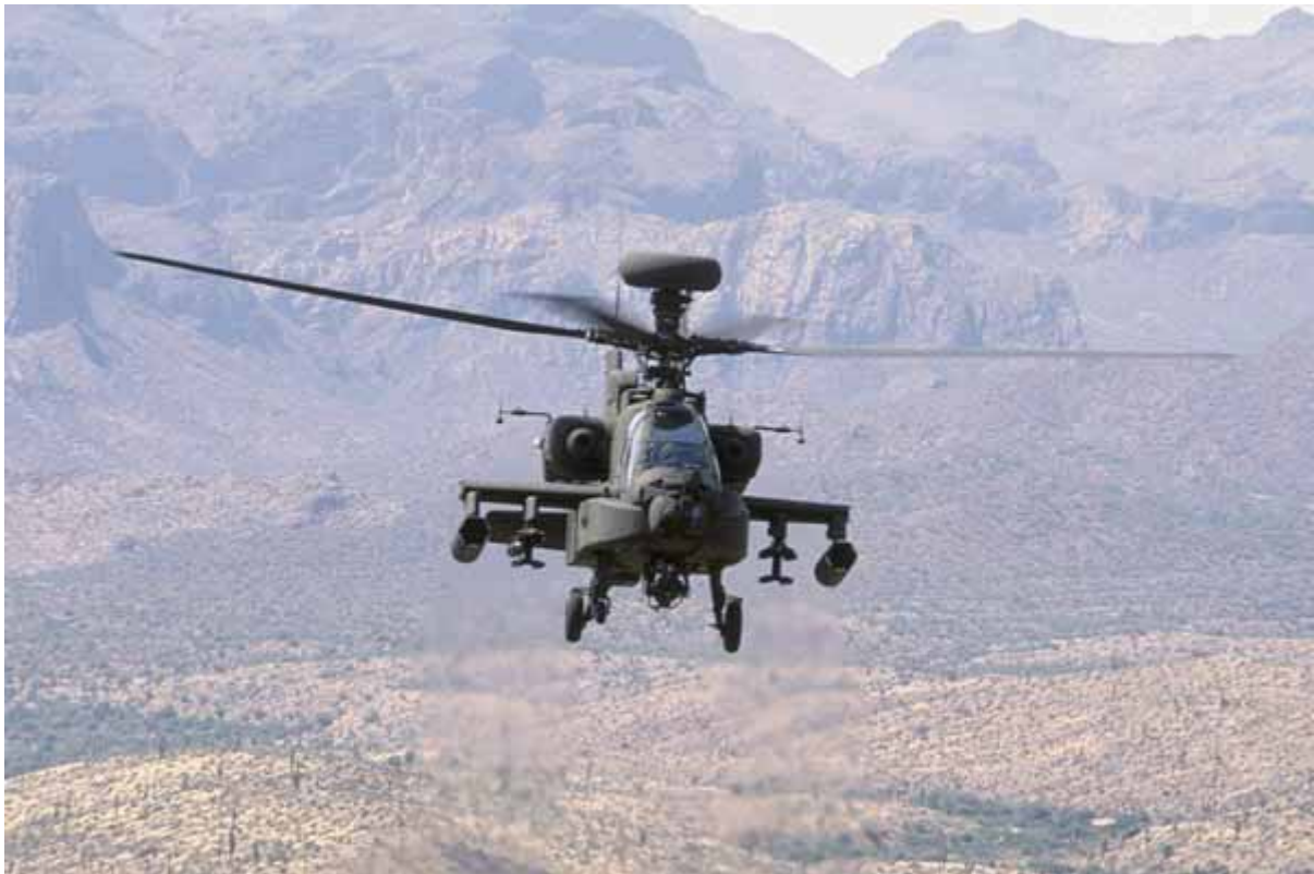
Kuva 184: AH-64 Apache-taisteluhelikopterin Longbow-versio on varustettu millimetriaaltoalueen tulenjohtotutkalla ja interferometrisuuntimolla. [Boeing]
