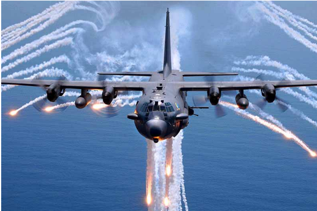
Kuva 339: Suuren lentokoneen lämpöheräte on niin iso, että koneen suojaaminen edellyttää suuren soihtumäärän käyttämistä, mitä kuvassa demonstroi erikoisjoukkojen AC-130H. [USAF]
