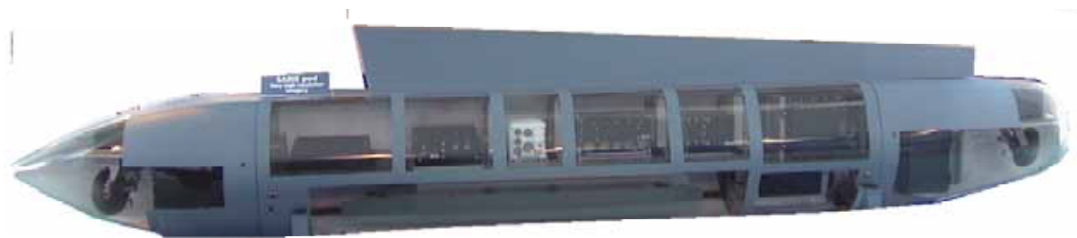
Kuva 163: SAR-tutka voidaan asentaa myös lentokoneeseen ripustettavaan säiliöön. [J. Kosola]
