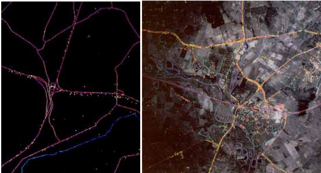
Kuva 172: Vasemmalla SAR-tutkan GMTI-moodissa (Ground Moving Target Indicator) havaitsemia liikkuvia maaleja yhdistettynä tieverkon malliin. Oikealla tieverkko ja dopplertaajuuden avulla havaitut liikkuvat maalit esitettynä tavallisen SAR-kuvan päällä. [USAF ja Northrop Grumman]
