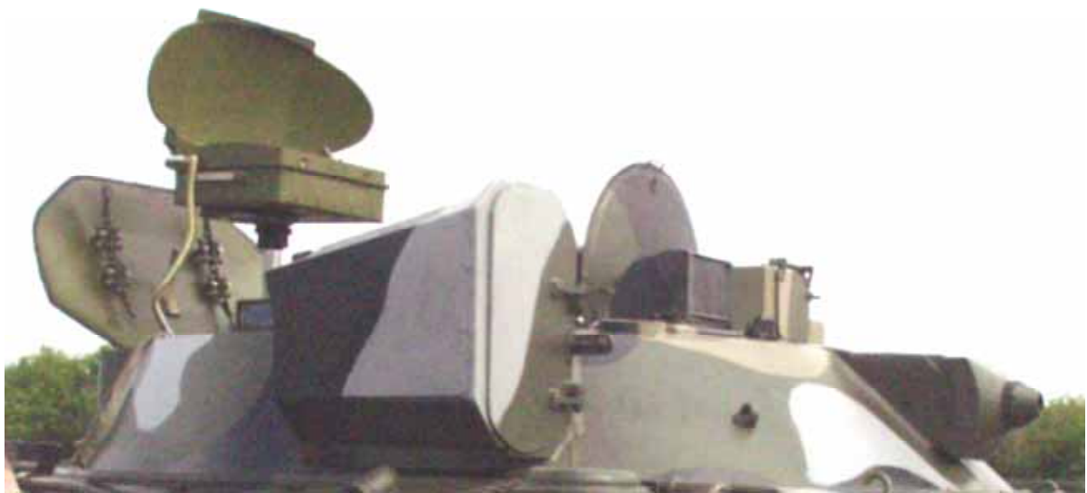
Kuva 177: Venäläiseen tulenjohtopanssarivaunuun asennettu maasto- valvontatutka. [J. Kosola]
