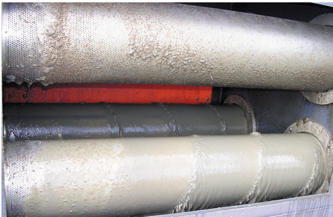
Kuva 2. Milstonin seuloista valuu nestettä ruuvin aiheuttaman paineen ajamana. Kuva: Sakari Lehtinen
