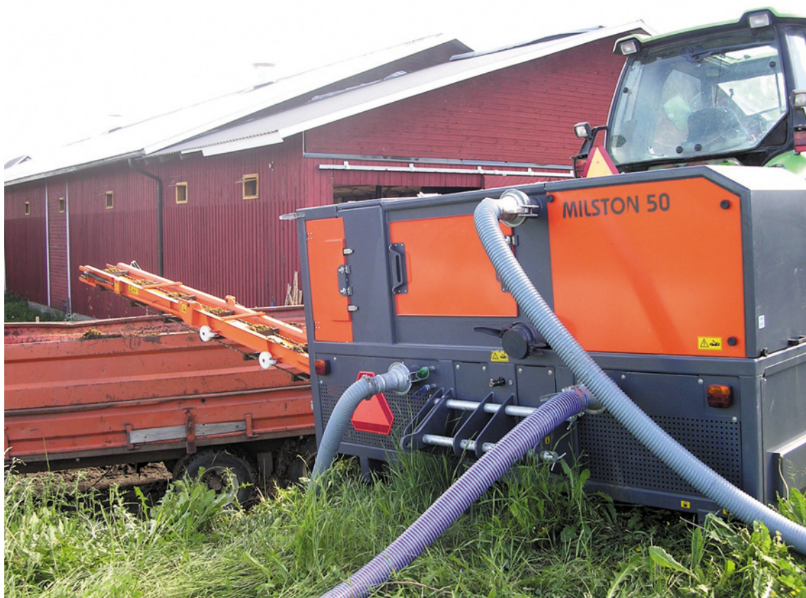
Kuva 3. Kokeilussa käytetty Milston 50A ruuviseparaattori traktoriin kytkettynä. Kuva: Sakari Lehtinen
