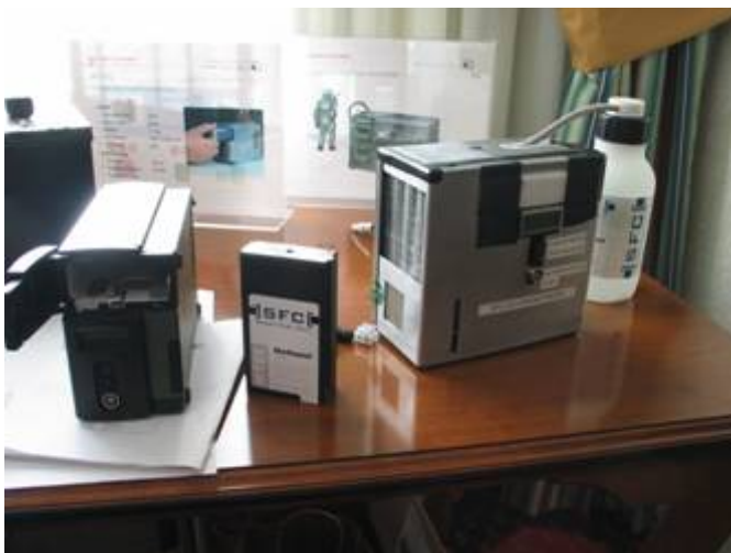
Kuva 27: Markkinoilla oleva polttokennolla energiaa tuottava yksikkö [20].
