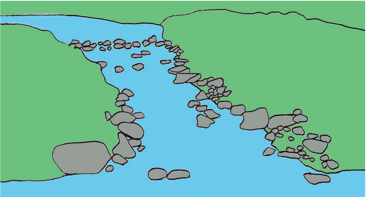
Kuva 31. Kiviset pohjapadot ovat maisemallisesti kauniita elementtejä. Tällaisissa padoissa myös kalojen kulku on mahdollista.
