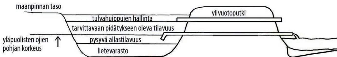
Kuva 23. Putkipadon rakenne.
