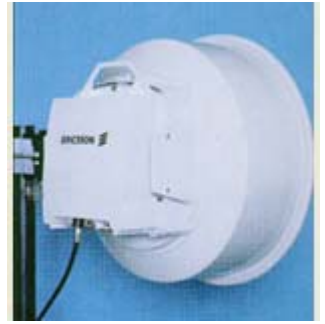
Kuva 2.5 RAU2 ja 0.6m antennimoduli
