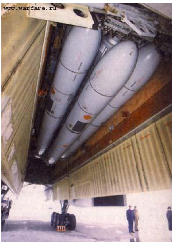
Kuva 10: Kh-55 ohjuksia Tu-95MS koneen MKU-5-6 laukaisimessa[30]
