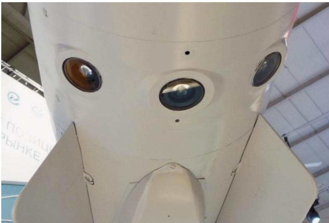
Kuva 7: Kh-59MK2 ohjuksen EO-sensorit ohjuksen etuosan alapuolella[18]
