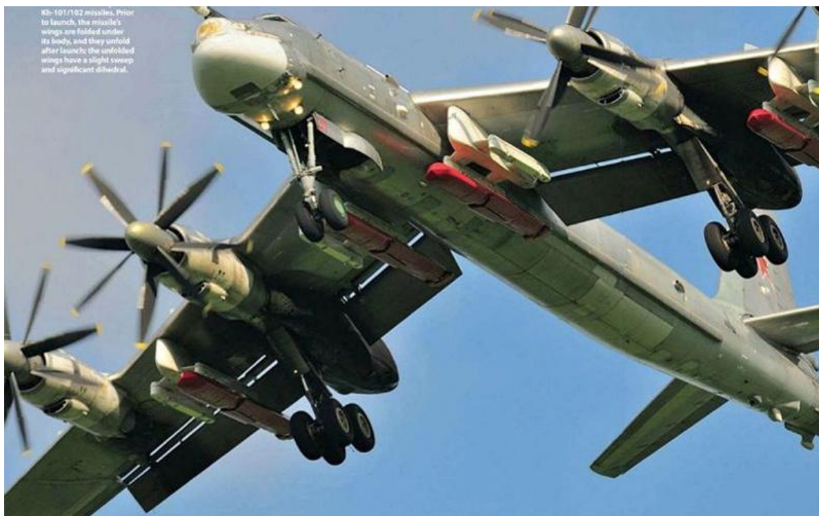
Kuva 5: Kh-101 ohjuksia Tu-95MS:n ulkoisissa ripustimissa. Ohjusten alapuolella näkyvät kuljetuksen ajaksi rungonmukaisiksi taittuneet siivekkeet[23]
