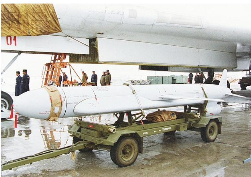
Kuva 4: Kh-55SM. Ohjuksen sivuilla näkyvät polttoainesäiliöt[2]
