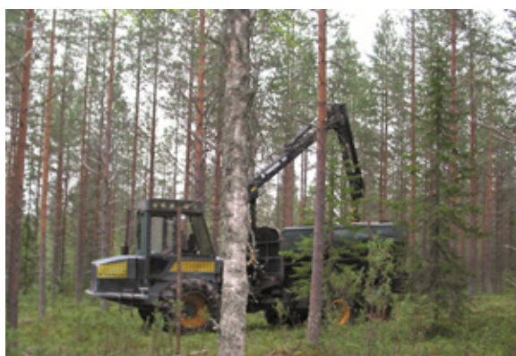
Kuvat 49 ja 50. Markku Komulaisen metsätraktorissa on kahmari, kolakuljetin ja keskipakolevitin.
