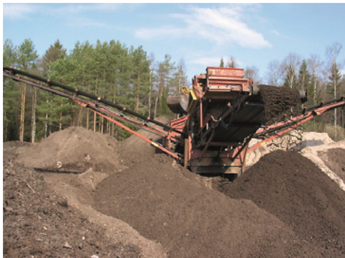
Kuva 55. A. & E. Juntunen Oy:n kolmitasoseulalla Kajaanin Auralassa voidaan seuloa kompostia ja sekoittaa siihen seosaineita (kalkki, tuhka, hiekka). Yrittäjä kutsuu valmista tuotetta biomullaksi. Kuva biomullan valmistuksen työnäytöksestä 14.5.2010.
