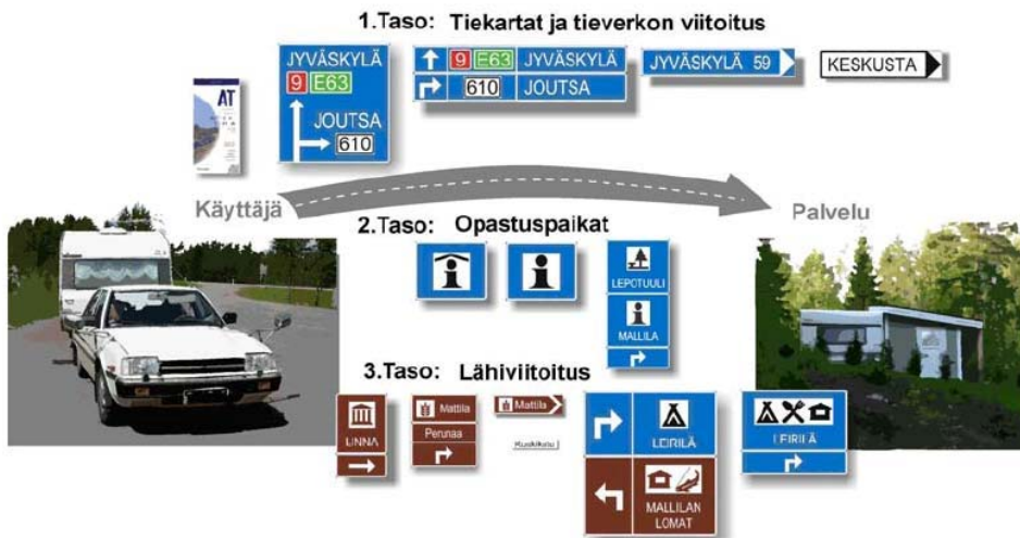
Kuva 1. Tieliikenteen opastusjärjestelmän kolmitasoinen rakenne.
