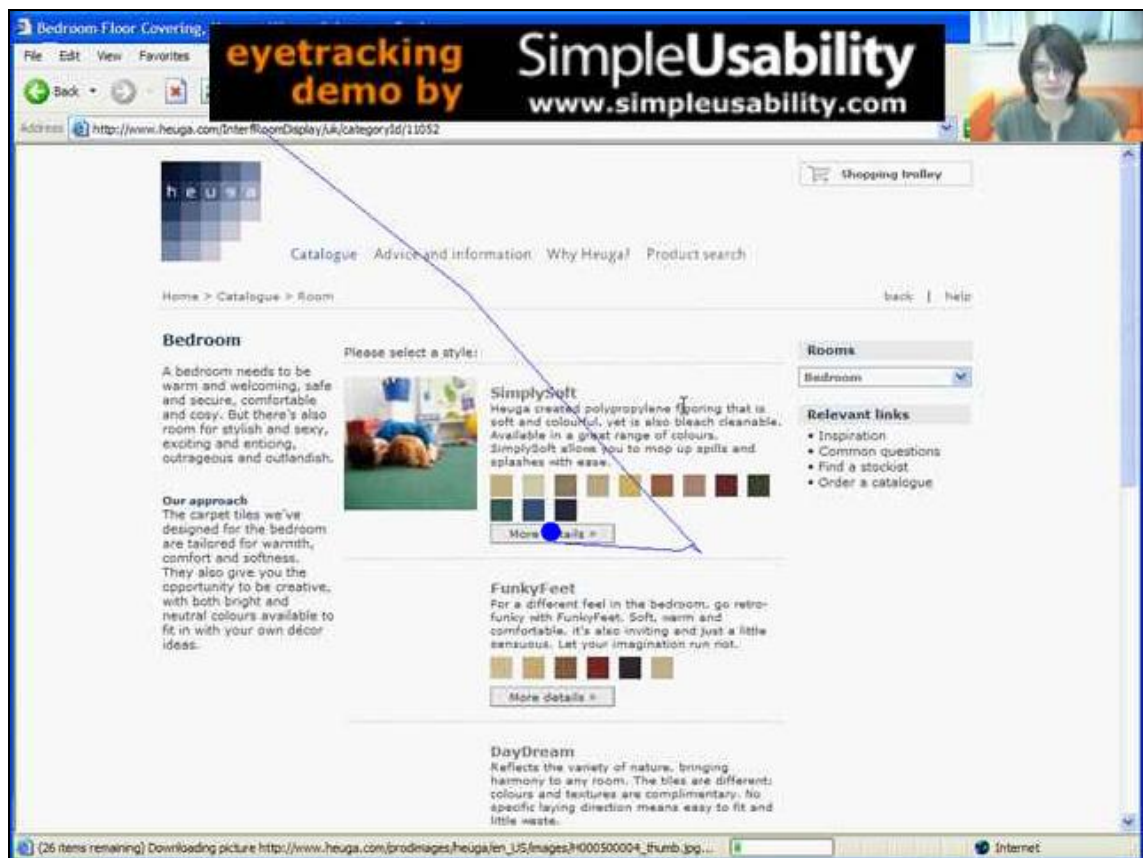
Kuva 8. SimpleUsability Ltd:n käytettävyystutkimusteknologiaa. Laitteisto tallentaa käyttäjän liikkumisen sivustolla, hänen puheensa sekä videokuvan hänen kasvoistaan. Käyttäjän katseen liikkeitä näkyvät tallenteessa sinisenä viivana ja viivan päähän kasvava pallo osoittaa katseen pysähdysten paikat ja kestot. (SimpleUsability.)
