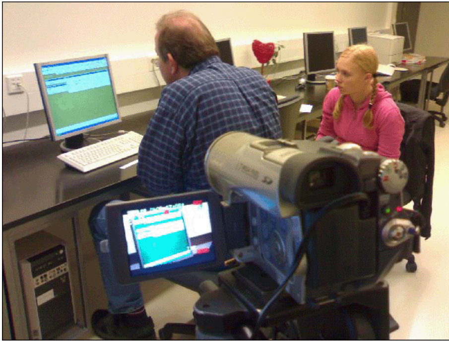
Kuva 9. Mestan käytettävyydestauslaitteisto. Jalustalla oleva videokamera kuvaa ruudun tapahtumat ja nauhoittaa testihenkilön kommentit.
