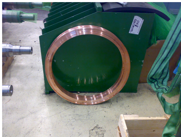
Kuva 5. Erilliset kuparitangot ja oikosulkurenkaat
