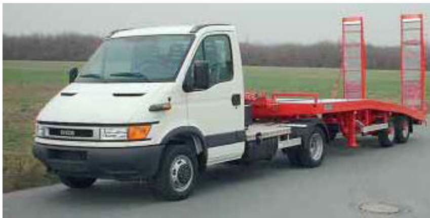
Kuva 32. Minisattelia voidaan käyttää myös ajoneuvojen kuljettamiseen [41].
