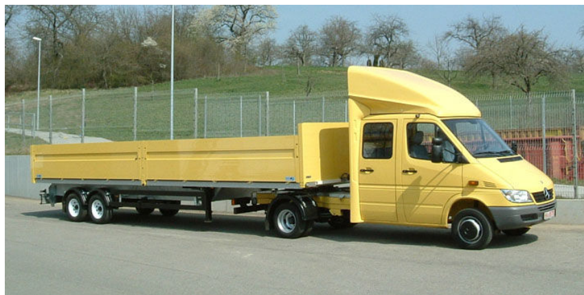
Kuva 30. Minisattel lavalla varustettuna [40].
