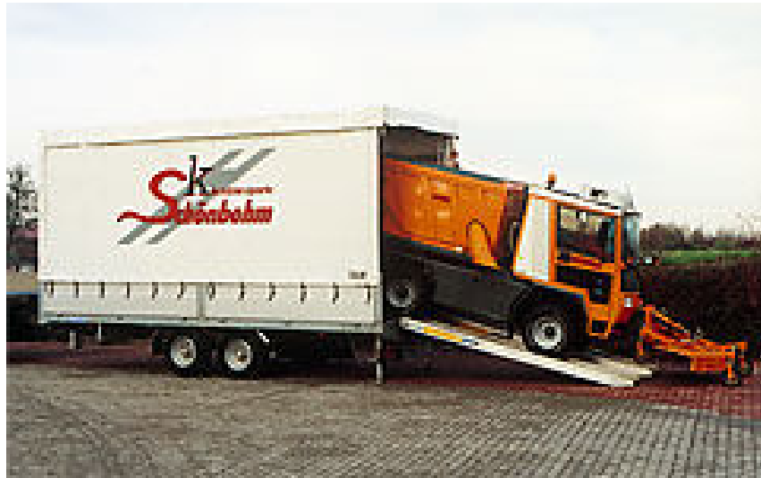
Kuva 43. Kääryllä voi kuljettaa vaikka lakaisinkonetta [46].
