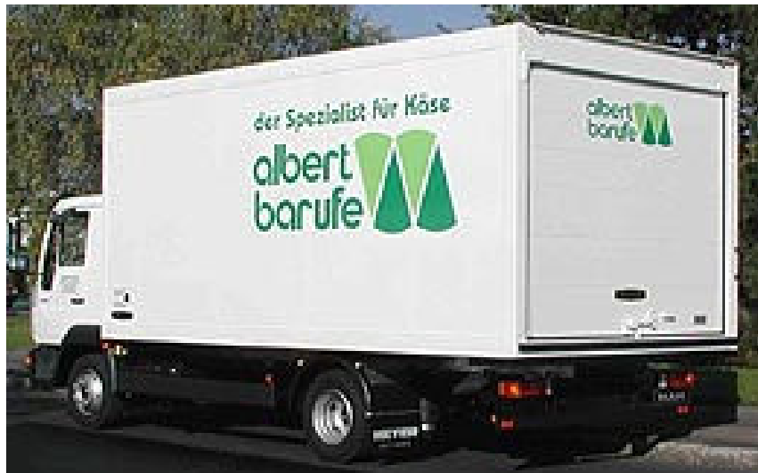
Kuva 46. Jakelija kevyemmällä nostettavalla takaovella [39].
