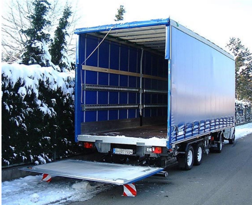
Kuva 31. Liukuverholla ja perälaudalla varustettu kuormatila [40].
