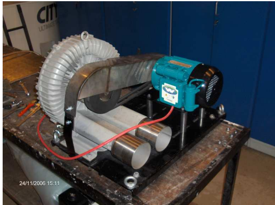
Kuva 13. Uusi sähkömoottori ja pumppu
