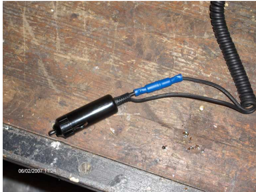
Kuva 17. Jännitteensyöttöpistoke ja jälkeenpäin rakennettu sulake. Käytetty 0,5 A:n sulaketta ja AMP -liitinta
