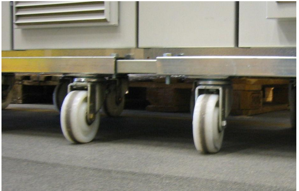
Kuva 12. Rulla-alustojen liittäminen toisiinsa reikäraudalla.
