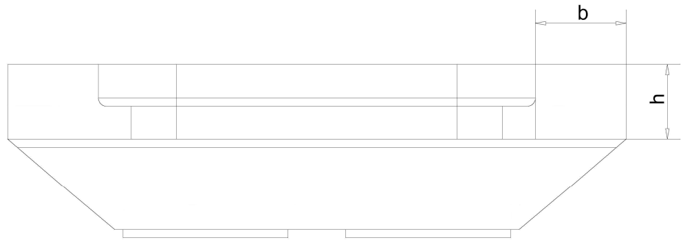
Kuva 19. Vestiraudan pulttikiinnitystason ohuimman osuuden mukainen halkaisuprofiili.
