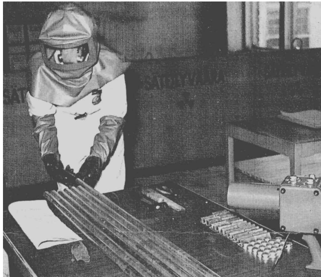
Figur 14. Uran laddas i ett kapslingsrör i Varkaus. (Författarens arkiv).
