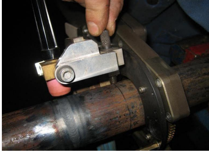
Kuva 78. Hitsattavan railon kohdalle asetettava elektrodin etäisyys säädetään kohdalleen säätöruuvilla.
