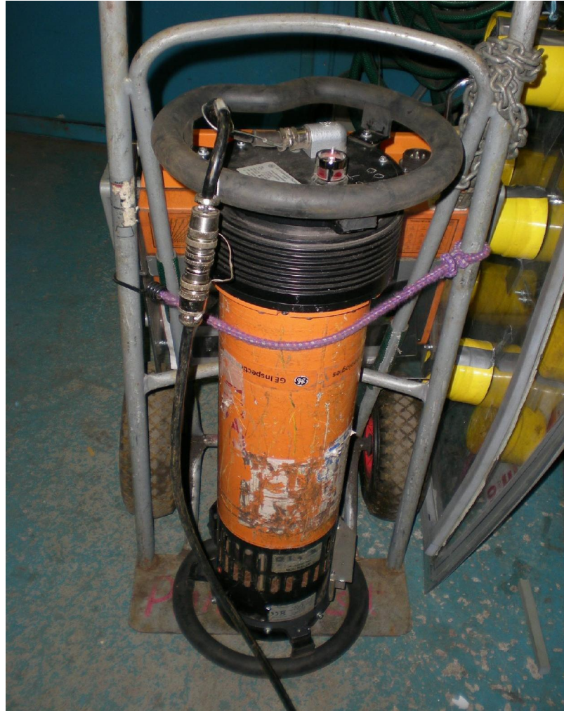
Kuva 102. RT-tarkastuksessa käytetty teollisuuskuvaukseen tarkoitettu röntgenputki
