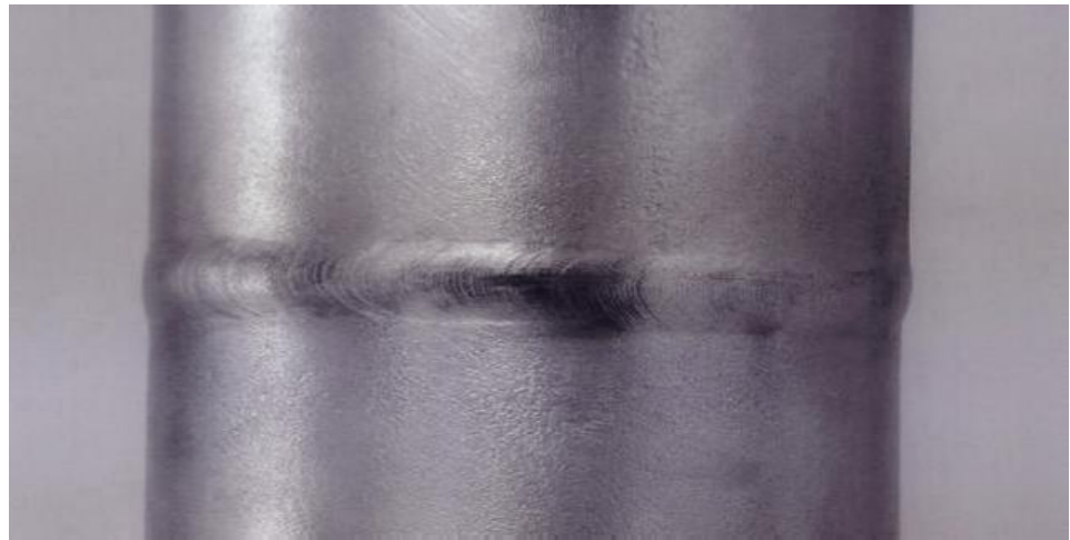
Kuva 88. AISI 316 L:n \text{Ø } 60,3 \times 2,0 virheetön pinta
