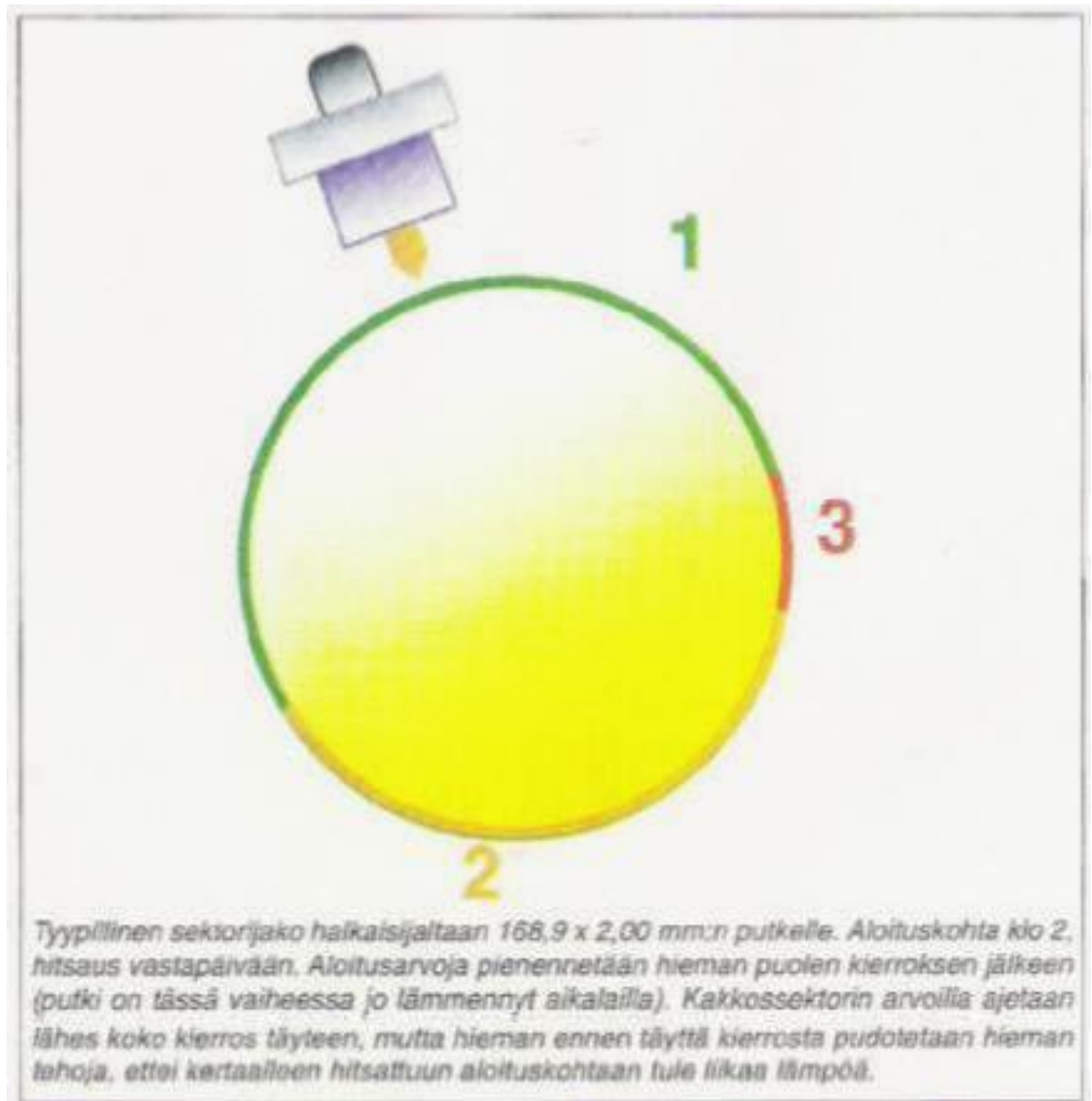
Kuva 68. Hitsausparametrien ohjelmointi sektoreittain [15, s. 29]
