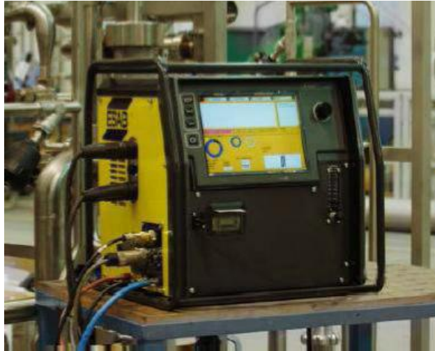
Kuva 32. Orbitaalihitsausvirtalähde Aristo MechTig C2002i, johon on integroitu vesi-jäähdytys ja ohjelmointipaneeli [18]
