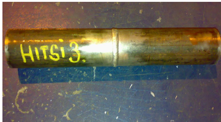
Kuva 98. Saumattoman ja seostamattoman teräsputken (NS40) kokonaisaika asetuksiin orbitaali-TIG-hitsaten on n. 11 minuuttia
