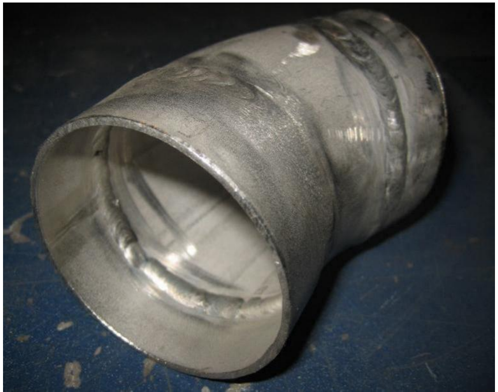
Kuva 9. Juurikaasulla suojattu kirkaspintainen hitsi.
