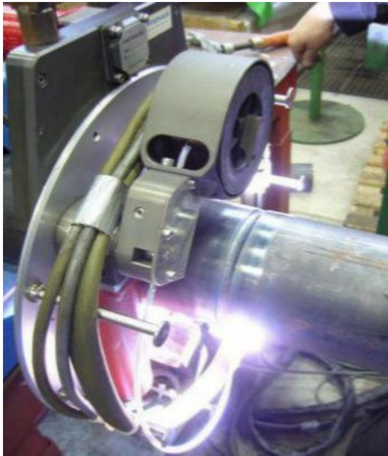
Kuva 60. Paksuseinäisen putken monipalkko-orbitaalihitsausta [21]
