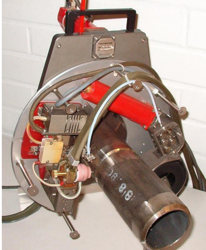
Kuva 37. MU IV- avopihti, jossa mukana AVC, OCS ja integroitu langansyöttö (ks. kpl 8.2.1) [14]
