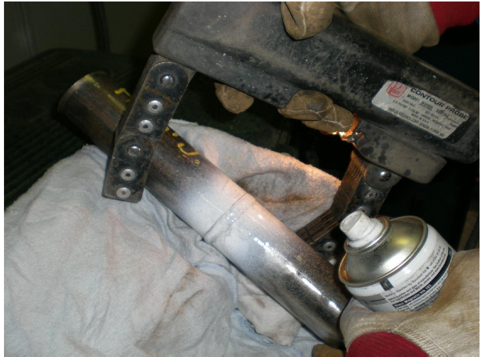
Kuva 107. Magnetointi sektoreittain, ruiskuttaen samalla magnetoituvia partikkeleita hitsin pintaan
