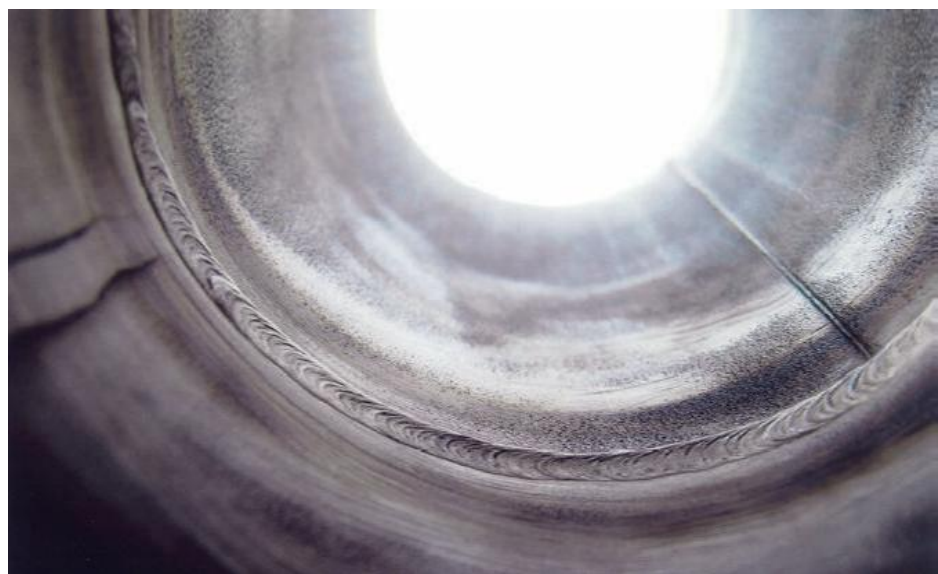
Kuva 89. AISI 316 L:n \text{Ø } 60,3 \times 2,0 laadukas juuri
