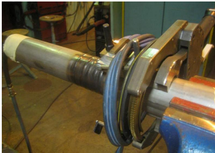
Kuva 84. Orbitaalihitsausprosessi valmiina alkamaan
