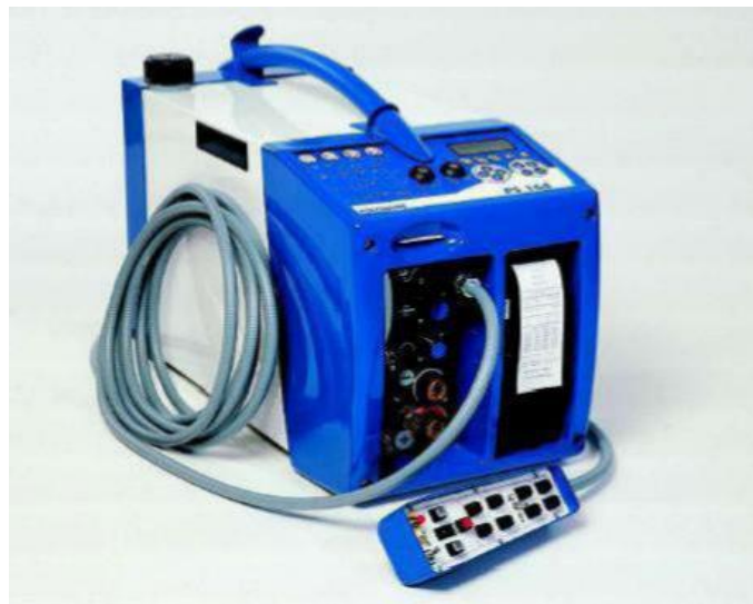
Kuva 50. Virtalähteeseen PS-164 sisäänrakennettu kirjoitin hitsauksen tosiarvojen tulostamiseksi [14]
