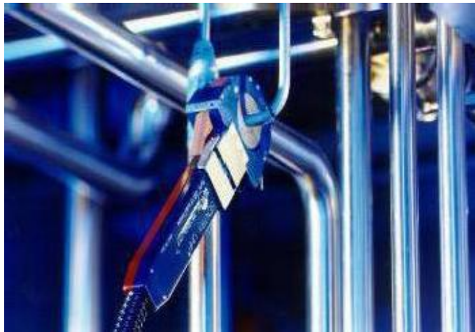
Kuva 41. Putkisto-osien hitsausta umpipihdillä [14]
