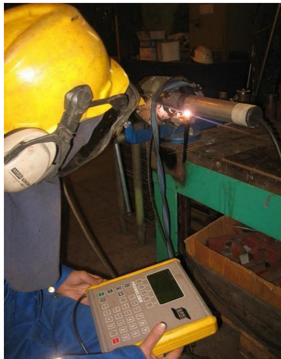
Kuva 100. Työasennot muuttuvat orbitaali-TIG-hitsauksen myötä huomattavasti vähemmän kuormittaviksi.
