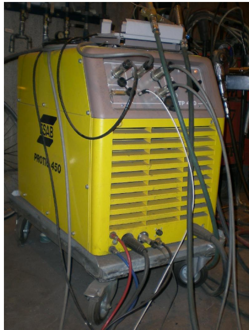
Kuva 72. Aker Yardsin Turun telakalla käytössä oleva Protig 450-virtalähde, joka soveltuu monipalkohitsaukseen (ks. kpl 8.2)
