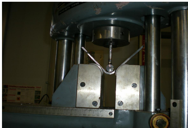
Kuva 118. Taivutintelaä painaa koesauvaa tasaisella kuormalla
