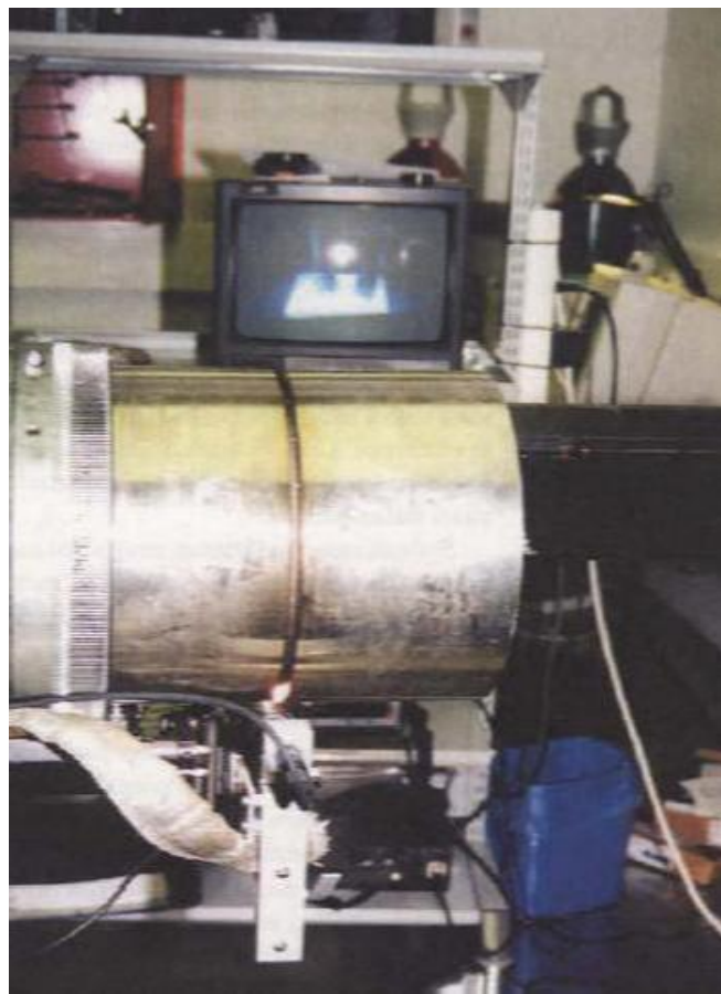
Kuva 47. Hitsauspähän kiinnitetty kamera välittää kuvan hitsauksesta [4, s. 26]
