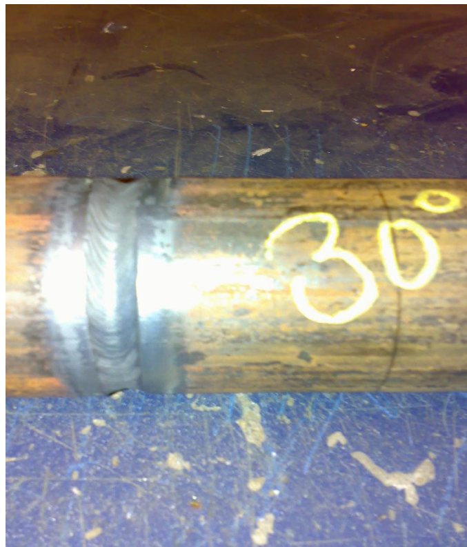
Kuva 97. 30° viistekulmalla tehtyyn V-railoon ajettu juuripalko ilman pintapalkoa
