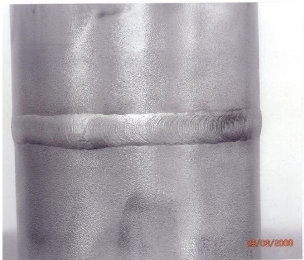
Kuva 87. Koehitsin (AISI 316L) virheetön pinta
