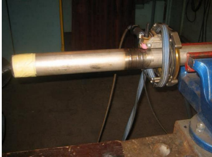
Kuva 83. AISI 316 L:n kiinnitys hitsausta varten
