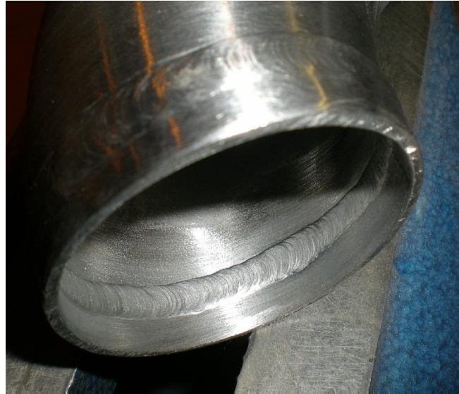
Kuva 69. Valmis tasakokoinen ja tunkeumaltaan samanlainen joka puolelta putkea oleva AISI 316 L:n orbitaalihitsi
