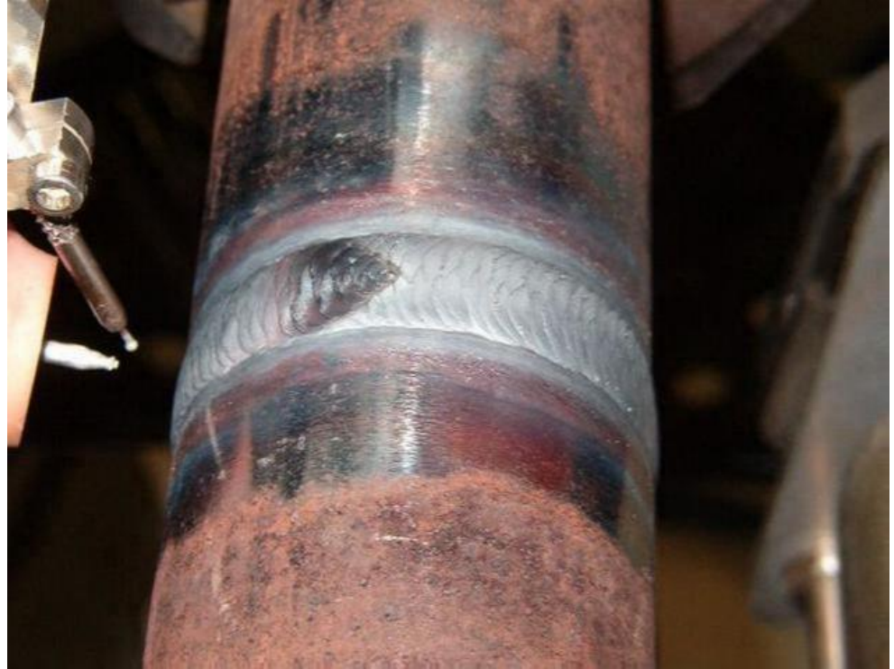
Kuva 63. Laadukas levityслиikkein saavutettu orbitaalihitsin pintapalkko [21]
