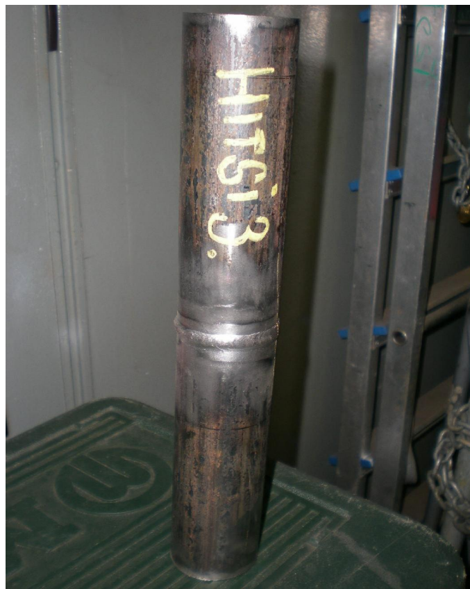
Kuva 101. VT-tarkastuksessa todettu hyvämuotoinen hitsi
