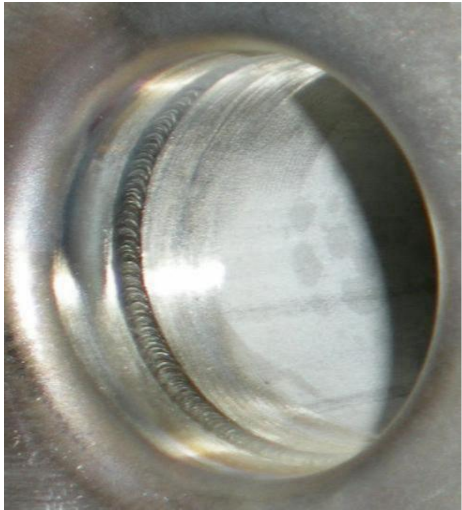
Kuva 21. Orbitaalihitsattu putken sisältä kuvattu laadukas hitsi.
