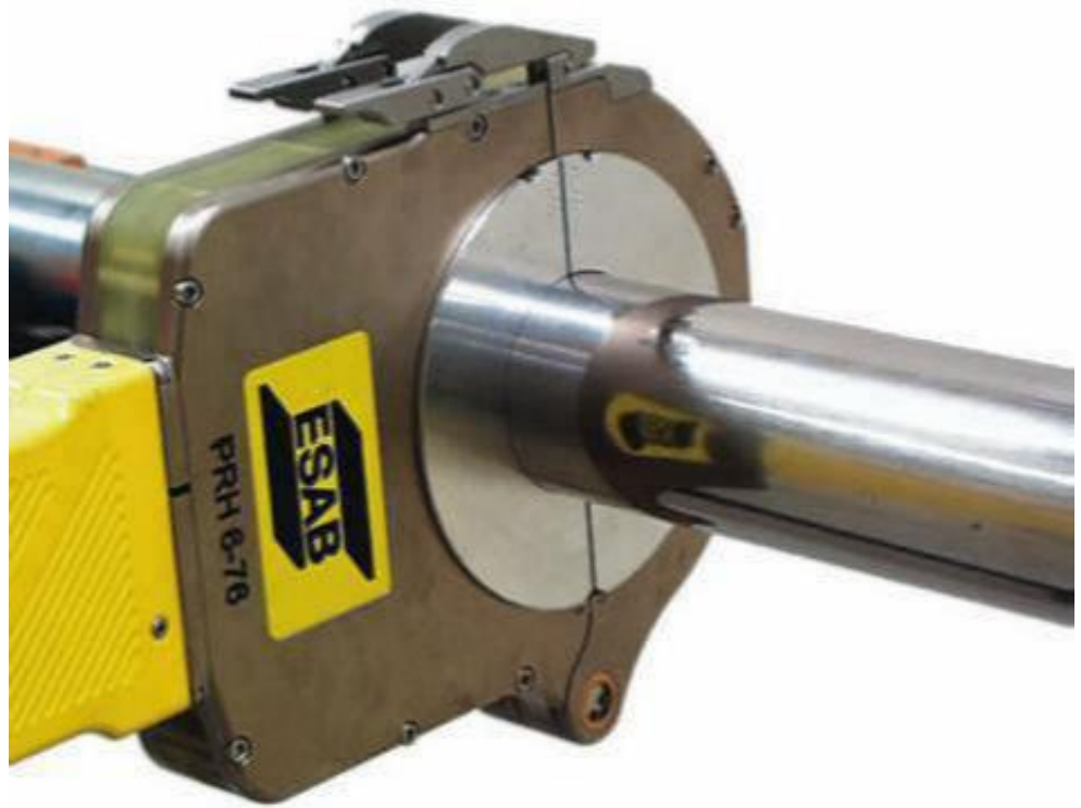
Kuva 39. Koteloitu hitsauspihti PRH 6-76 (umpipihti) [20]
