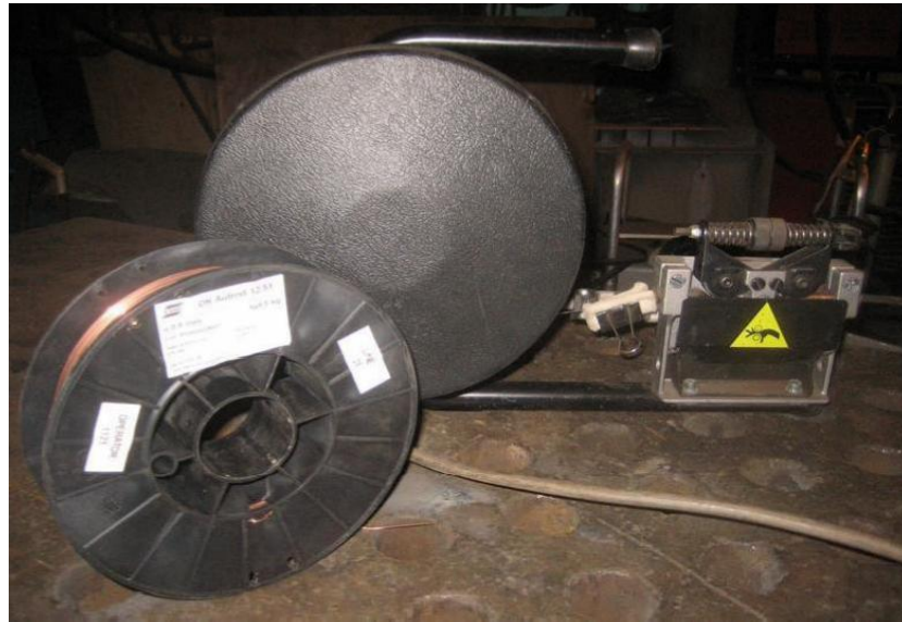
Kuva 18. Mekanisoidun TIG-hitsauksen langansyöttölaite ja kelalla oleva hitsauslisäaine.
