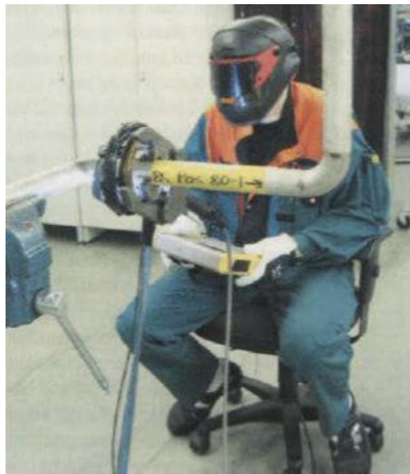
Kuva 22. Ergonomia parantuu huomattavasti siirryttäessä käsinhitsauksesta orbitaalihitsaukseen [11, s. 29]
