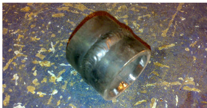
Kuva 99. Saumattoman ja seostamattoman teräsputken (NS40) kokonaisaika käsin-TIG-hitsaten on n. 40 minuuttia
