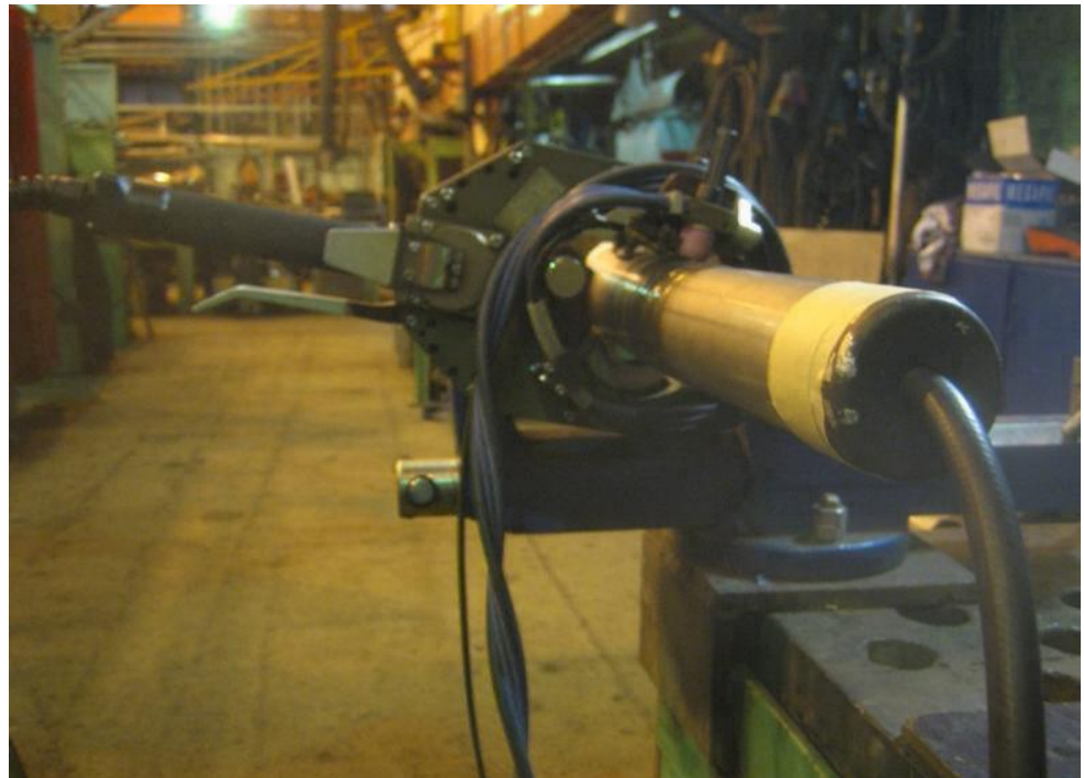
Kuva 19. Orbitaalihitsausta käyttäen pihityökalua.
