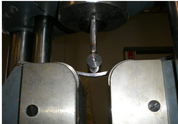
Kuva 117. Orbitaali-TIG-hitsistä otetun koesauvan taivutus alkamassa
