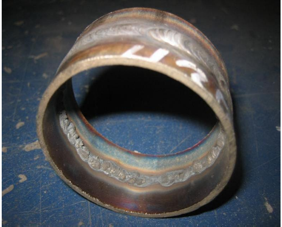
Kuva 8. Ruostumattoman teräksen hapettunut putki.
