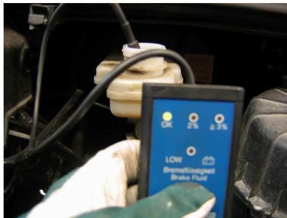
Kuva 6. Jarrunesteen vesipitoisuuden mittaaminen
