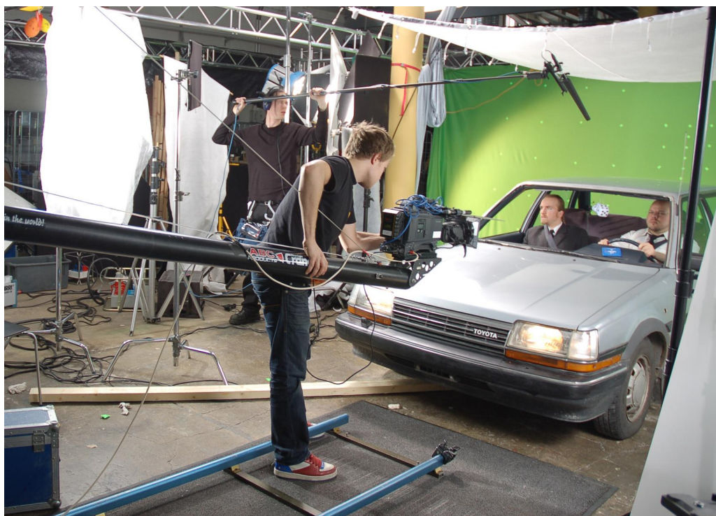
Kuva 17. ABC-kraanan ja lavetin avulla toteutettu kamera-ajo auton sisään.
