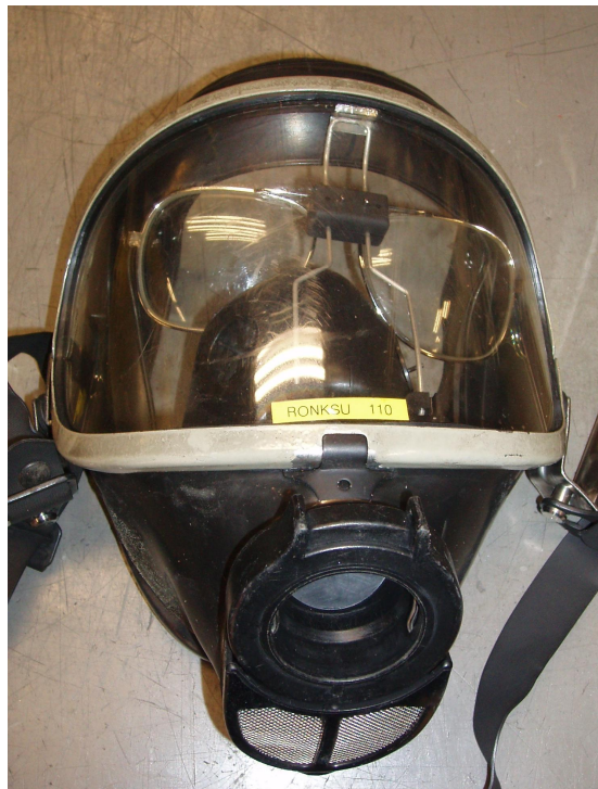
KUVIO 1. Paineilmahengityslaitteen kasvo-osa ja adapteri
