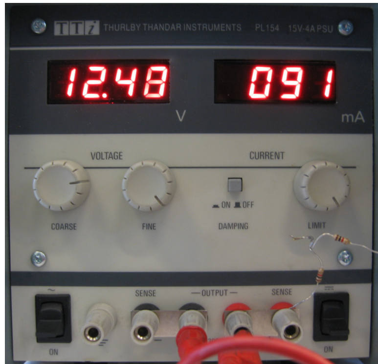
Kuva 12. Mikrokontrollerin koekäynnistys laboratorioteholähteellä
