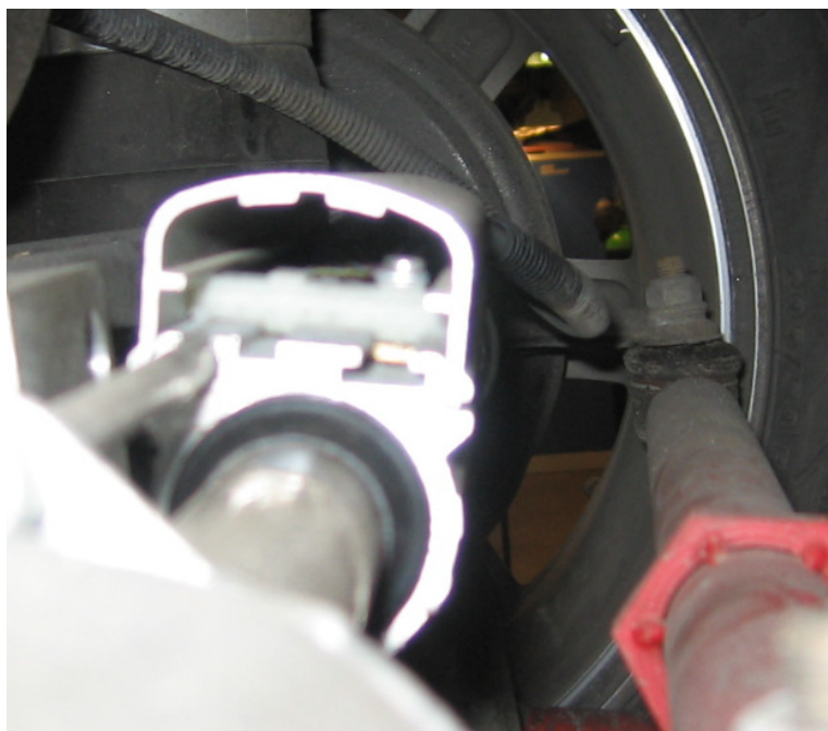
Kuva 5. REED-kytkimen sijainti karamoottorin ulkopuolella
