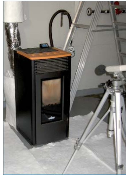
Kuvassa mitataan pellettikamiinan aiheuttamaa melua lämpökoeasemalla. Kuva: Jyrki Kouki
