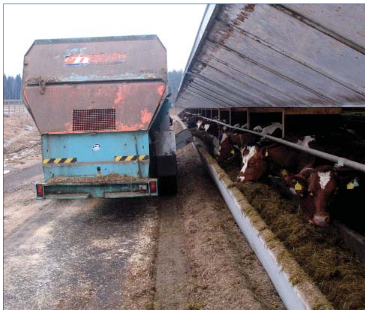
Kuva 8. Apevaunu kannattaa mitoitaa niin, että kapasiteettia ei jää käyttämättä ja toisaalta niin, että sitä on tarpeeksi. Jos joudutaan tai halutaan tehdä useampia seoksia, kapasiteetiltaan pienehkö vaunu riittää. Jos tehdään vain yksi seos, kannattaa hankkia kapasiteetiltaan riittävän suuri vaunu. Kasvattamolaskelmissa on tehty yksi seos päivässä. Kuva: Markku Lätti
