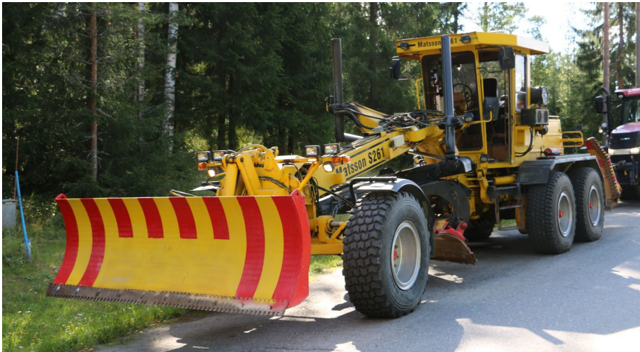
Kuva 1. Tutkimuksessa Kiteellä käytetty Matsson S261 tiehöylä (vm 1994, 20 tonnia).
