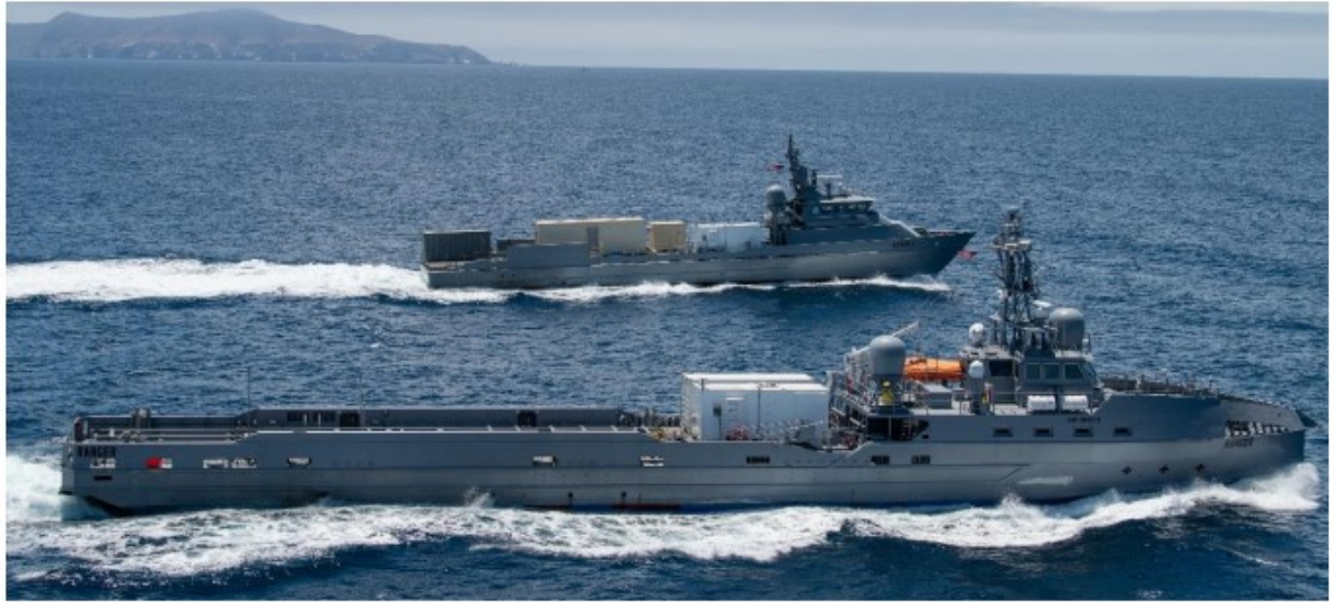
Kuva 5. Overload-kehitysohjelman miehittämättömien alusten prototyypit Ranger ja Nomad Yhdysvaltojen länsirannikolla 151
