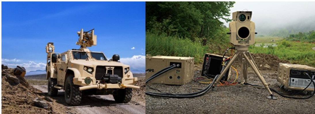
Kuva 12. Boeingin Compact Laser Weapon System (CLaWS) asennettuna ajoneuvoon ja kannettavana järjestelmänä [76; 75]
