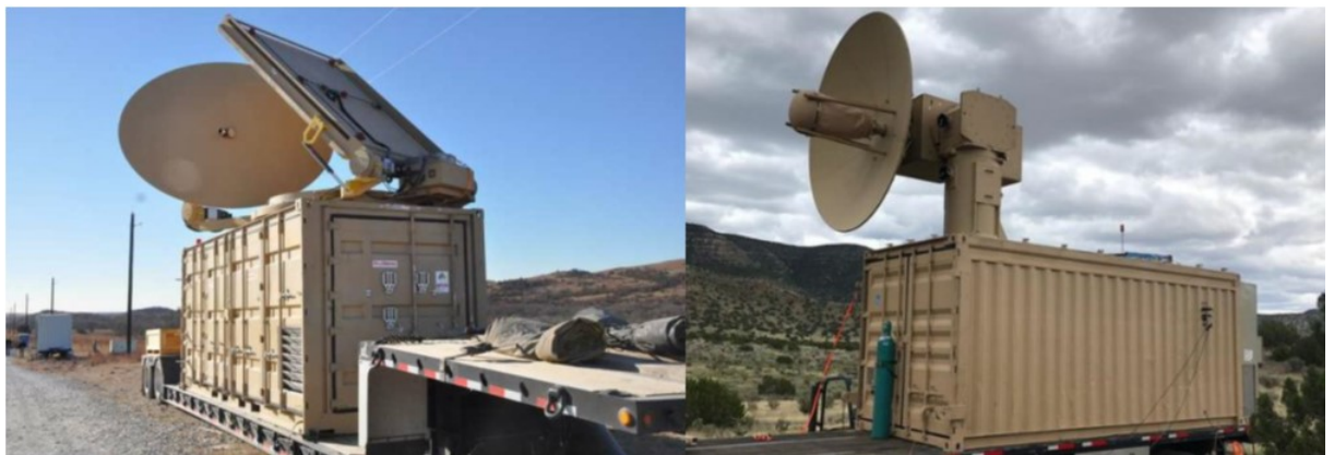
Kuva 10. Raytheonin Phaser (vasen) ja AFRL:n THOR -HPM-järjestelmät (oikea) [62; 63]
