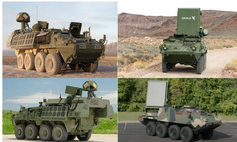
Kuva 8. Stryker-panssariajoneuvot aseistettuna Raytheonin 50 kW DE-MSHORAD - laseraseella (vasen) ja Epiruksen LEONIDAS -HPM-aseella (oikea) [19; 20]
