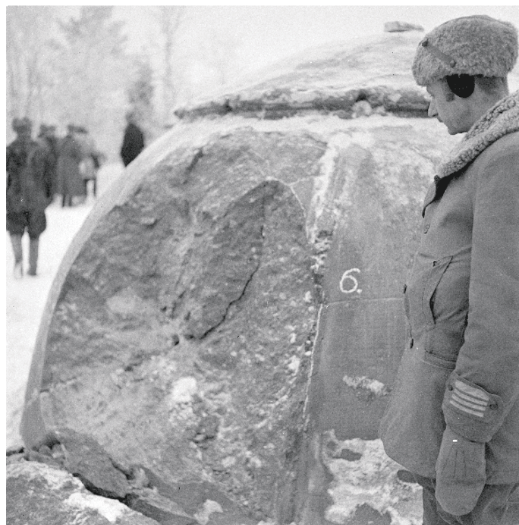
Imubetonikupujen kestävyyttä testattiin Ahijärvellä 45 K/38:n ja 76 K/36:n panssari- ja sirpalekranaateilla. Kuvassa Päämajan linnoitusosaston päällikkö, eversti Bonsdorff tarkastelemassa koeammunnan tuloksia 12. tammikuuta 1943. Kuva: alikersantti J. E. Soininen / SA-kuva
