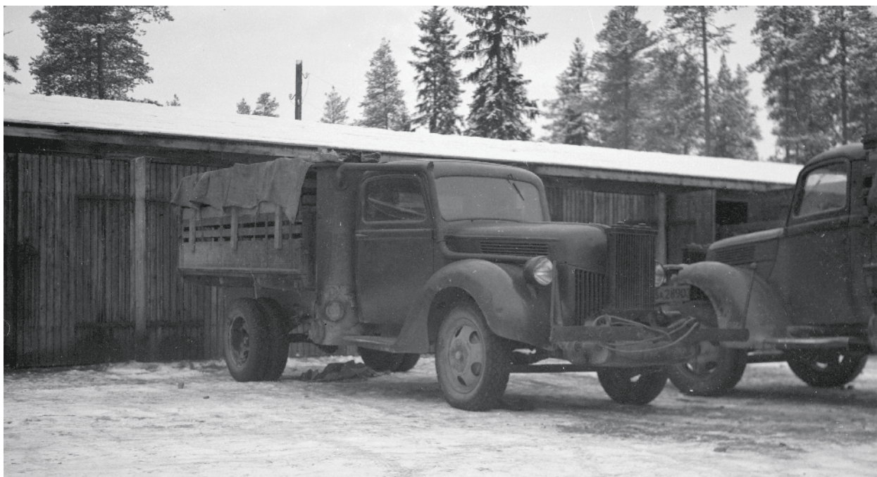
Armeijalle hankittiin jatkosodan aikana useita erimallisia hiilellä ja puulla toimivia ajoneuvoja. Kuvassa Imbert-kaasuttimella varustettu Ford-kuorma-auto testattavana 26. Autokomppanian häikääutokurssilla Lieksassa marraskuussa 1943. Kuva: kapteeni E. Harju / SA-kuva
