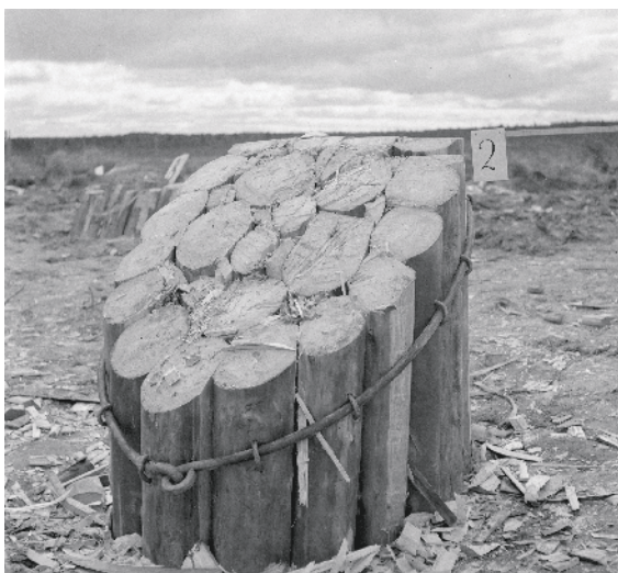
Kokeiluissa testattiin muun muassa erilaisten betonisärmiöiden, paalunippujen ja puusärmiöiden estearvoa. Kuvat: Ensio Lindholm, Osvald Hedenström, Hugo Sundström / SA-kuva
