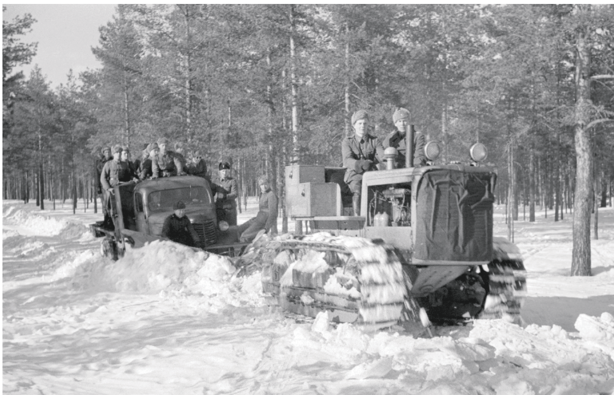
Laajan ampuma-alueen kunnossapidosta huolehtivat modernia liikkuvuutta edustaneet häikäpönttöiset henkilöauto ja kuorma-auto sekä tykkien siirtelyyn tarkoitettu telatraktori. Kuvassa tietä aurataan leirialueella huhtikuun alussa 1944. Kuva: kersantti Niilo Verronen / SA-kuva
