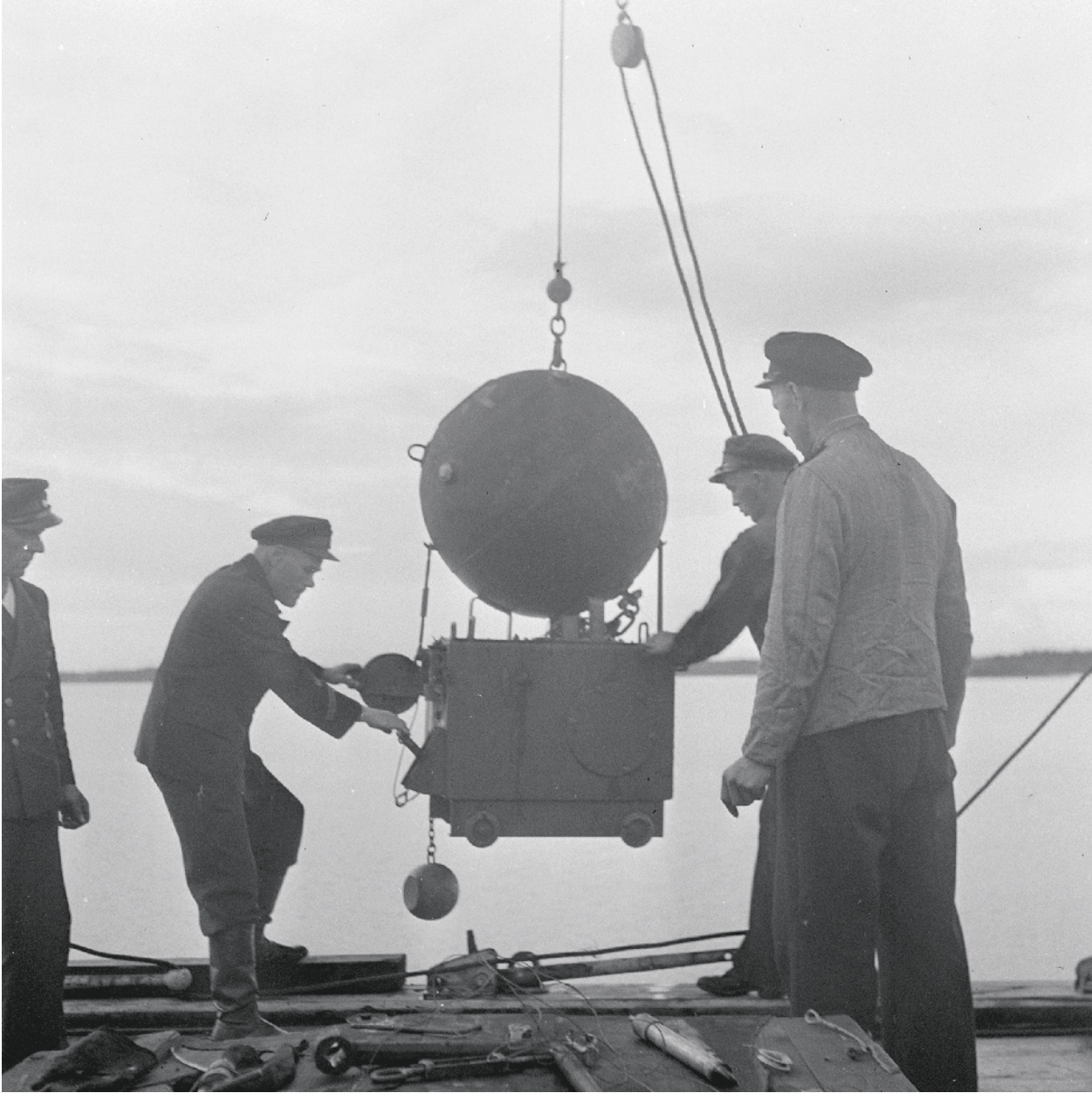
Laatikkoankkurin ja syvytinkoneiston oikea toiminta syvytytti miinan halutulle syvyydelle. Kuvassa on käynnissä S/43-miinan ankkurikokeilut Uudessakaupungissa heinäkuussa 1944. Kuva: sotilavirkailija Aavikko / SA-kuva
