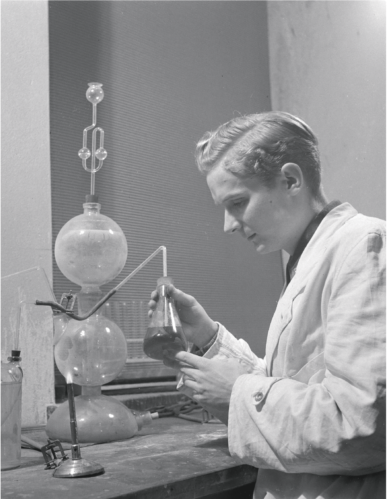
Laboratoriokokeita rintamaolosuhteissa. Kaasunkehitystä Kippin kojeella Viipurissa joulukuussa 1942. Sotilasvirkailija Tauno Ovaskainen / SA-kuva
