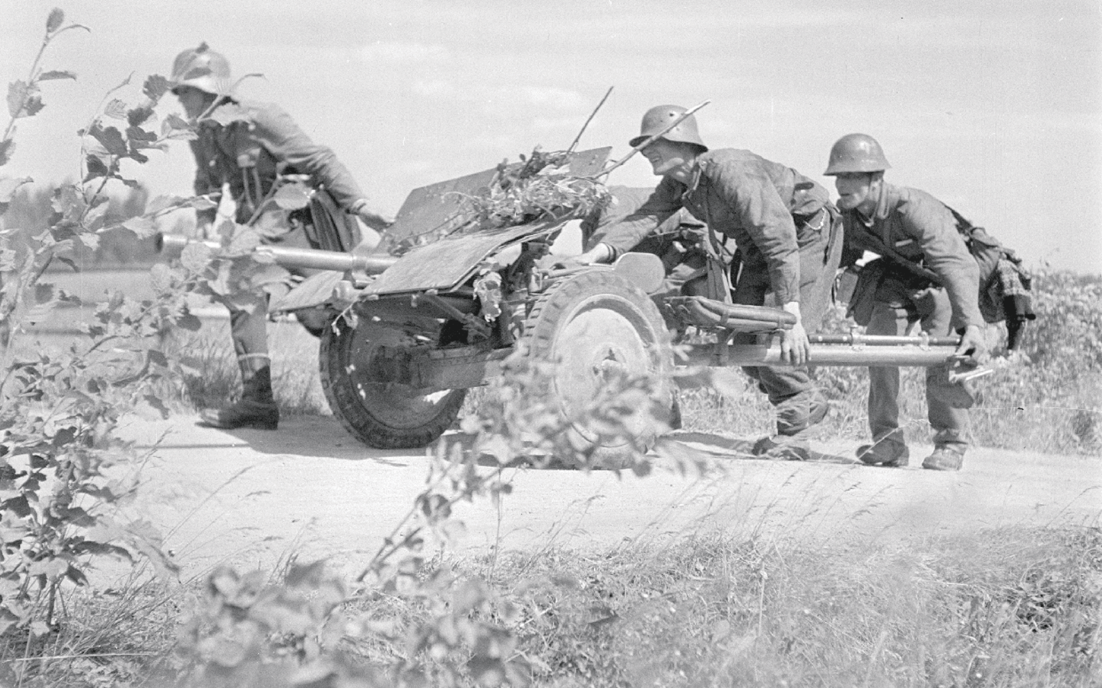
Ennen jatkosotaa toteutettujen läpäisykokeiden tarkoituksena oli selvittää panssarintorjunta-aseiden läpäisykykyä ja tuhovoimaa. Boforsin 37 mm:n pst-tykit osoittautuivat kokeiluissa parhaimmiksi. Suomalaisten pst-tykkiä viedään asemaan heinäkuussa 1941. Kuva: vänrikki Kim Borg / SA-kuva
