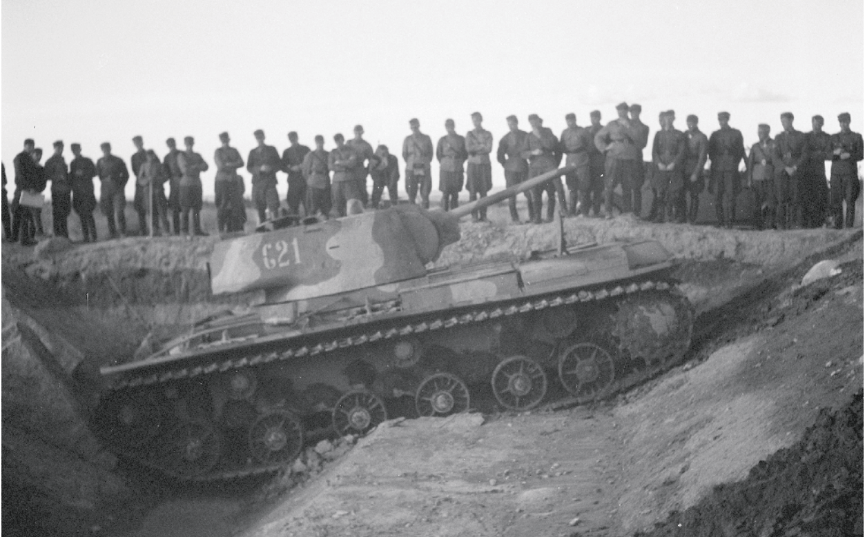
Panssarivaunujen etenemiskykyä testattiin myös kaivannoilla ja vastarinneleikkauksilla. Kaivantoeste, jonka vastaseinämälle oli asetettu kuvan vasemmassa reunassa näkyviä estekiviä, osoittautui ylitsepääsemättömäksi esteeksi KV-1-vaunulle. Kuva: Ensio Lindholm / SA-kuva
