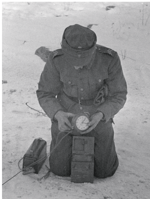
Sabotaasivälineiden kehitystyöhön kuului myös sotasaaliina saadun välineistön tutkiminen. Kuvassa puretaan vihollisen jäljiltä löytynyttä helvetinkoneeksi kutsuttua kellokoneistoa Koivistolla marraskuussa 1941. Kellokoneiston avulla panokset saatiin syttymään tarkasti haluttuna aikana. Kuva: sotilavirkailija Jarl Taube / SA-kuva
