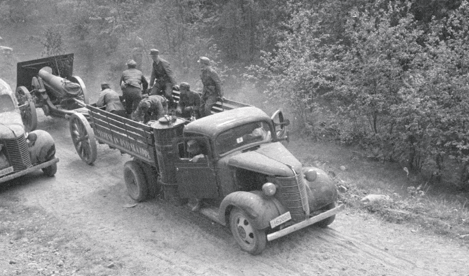
Polttoaineen saatavuus pakotti armeijan siirtymään puun käyttöön ajoneuvojen polttoaineena. Sota testasi ajoneuvojen kykyä selviytyä eri maastoissa. Kuvassa puukaasuttimella varustettu Chevrolet-kuorma-auto vetämässä haupitsia Tohmajärvellä heinäkuun alussa 1941. Kuva: sotilasvirkailija Tauno Ovaskainen / SA-kuva
