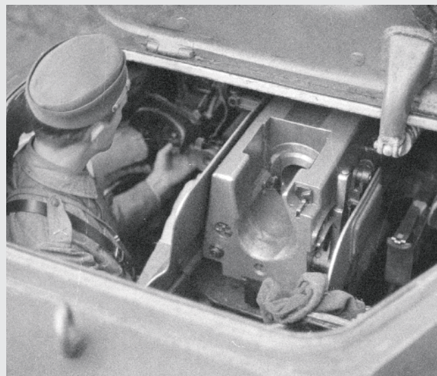
76 mm:n panssarivaunun kanuunan m/1940 – suomalaisittain 76 Psv K/34:n – peräkappale T-34:n tornin sisällä. Kuva: Tuovi Nousiainen / SA-kuva
