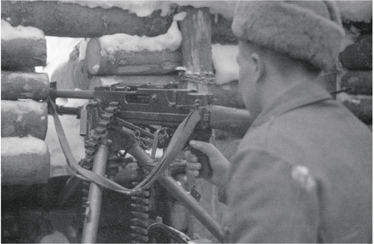
Aimo Lahden suunnittelema konekivääri L-41 Sampo Jalkaväkirykmentti 50:n käytössä Syvärillä joulukuussa 1942. Etutuelta konekivääriä oli mahdollista käyttää yhden miehen aseena. Kuva: sotilavirkailija C. G. Rosenqvist / SA-kuva
