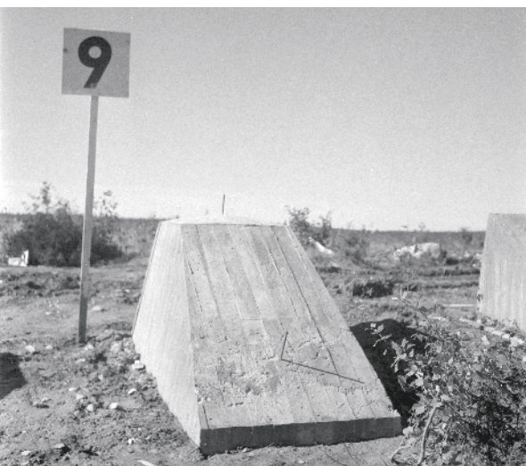
Kokeiluissa testattiin muun muassa erilaisten betonisärmiöiden, paalunippujen ja puusärmiöiden estearvoa. Kuvat: Ensio Lindholm, Osvald Hedenström, Hugo Sundström / SA-kuva
