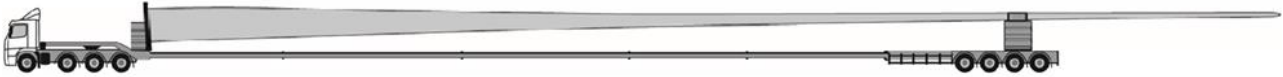
Kuva 6. Tuulivoimalan lapakuljetuksen pituus voi olla lähes 100 m ja kuljetuksen peräilytys aiheuttaa suuren pyyhkäisyn.
