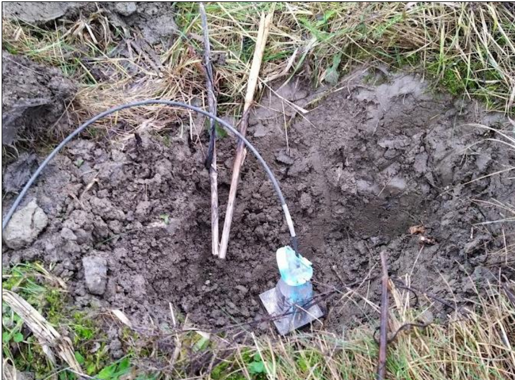
Kuva 30. Kiihtyvyyssanturi kiinnitettynä maaperään maaruuvilla.
