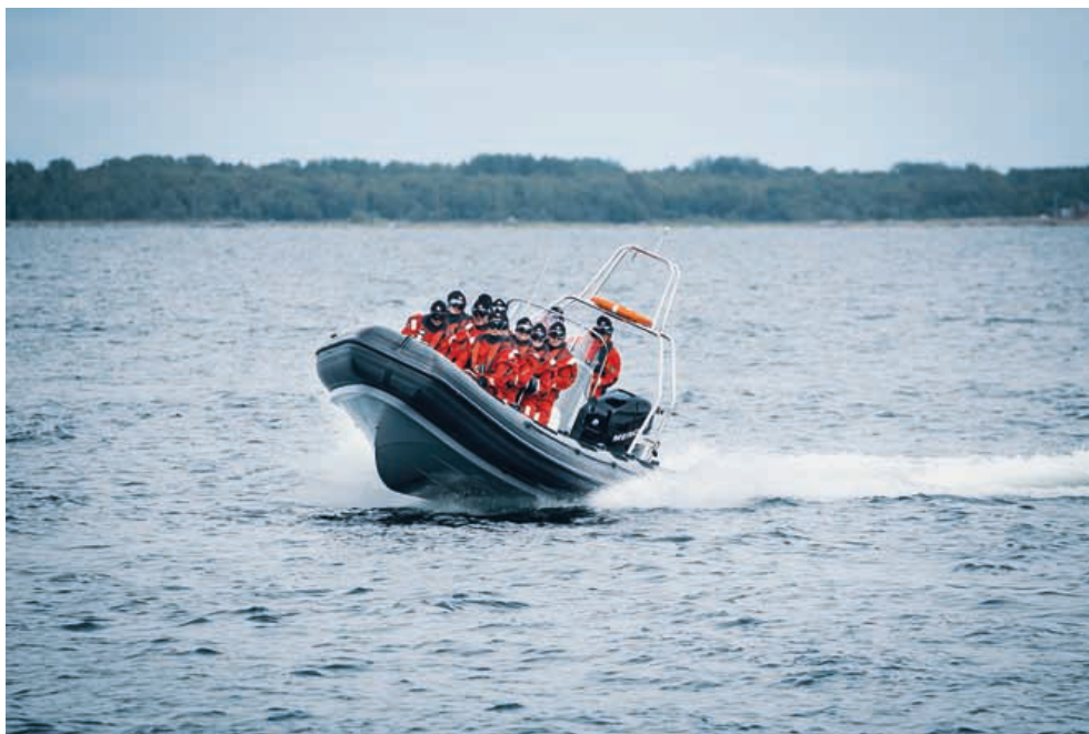
Ribbåten, en gummibåt med hårt botten, har två motorer på 275 hästkrafter vardera och en topphastighet på cirka 53 knop. Foto: Christoffer Björklund
