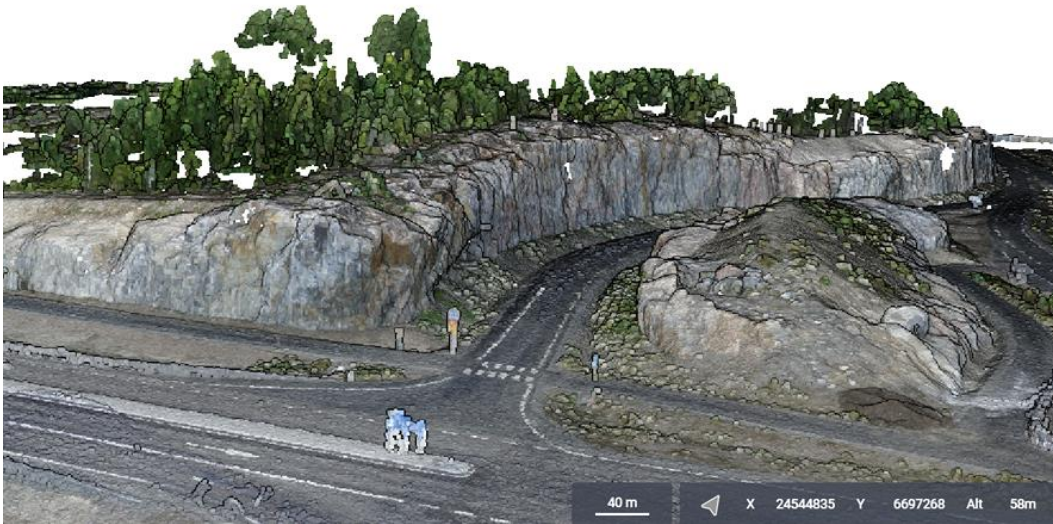
Kuva 17. Klaukkalan ohikulkutie Mt132:n pistepilvimalli Projektivelhon infraBIM-ympäristössä. Kuvassa hankkeen taitorakenteiksi luokiteltavia kallioleikkauksia.
