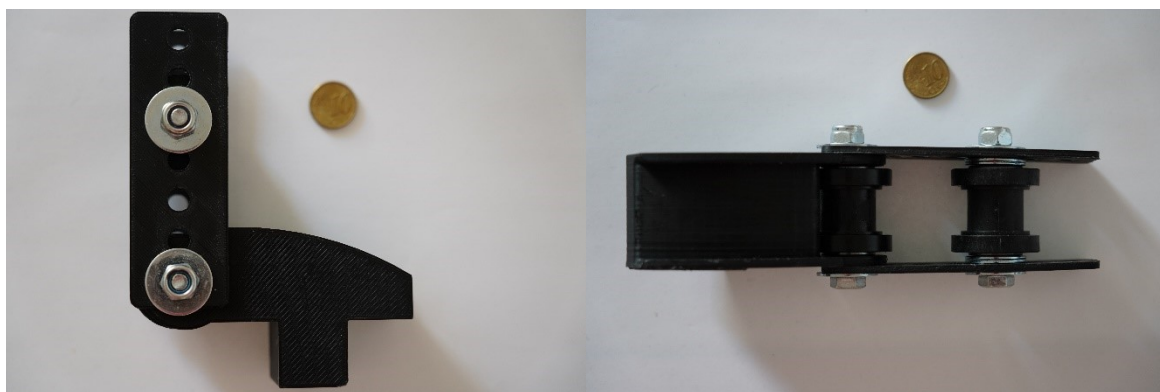
Kuva 19. Ketjunkiristin mallia 3, 3D-tulostettu PLAsta sekä rullat Nylonista.
