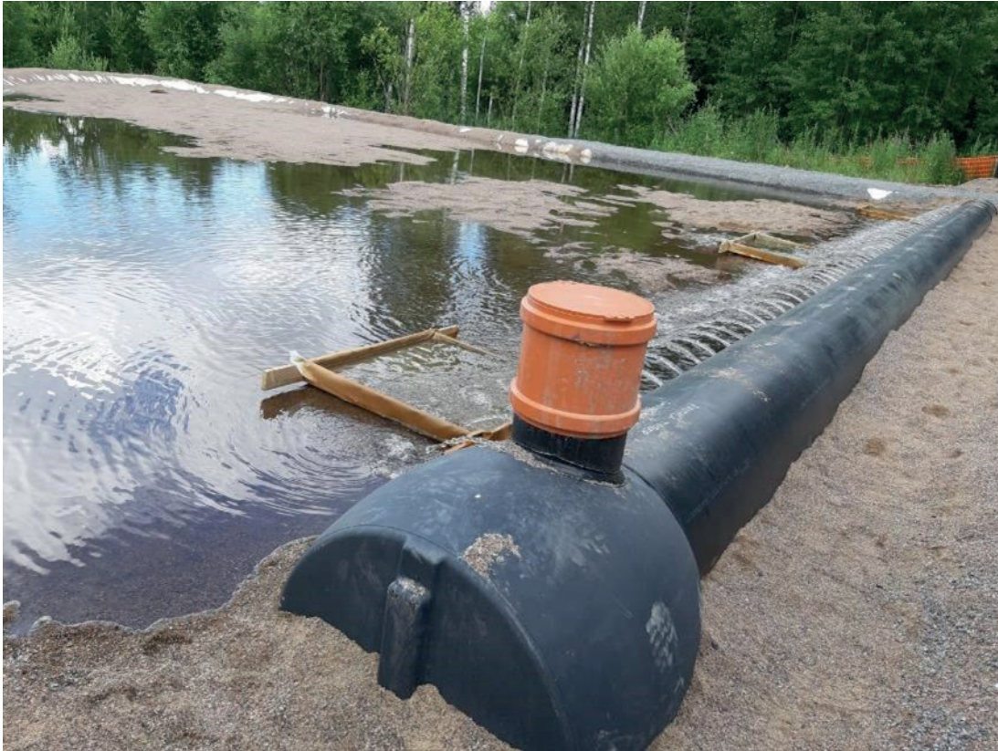
Kuva 40. Alusveden puhdistusjärjestelmän kokeilu Kymijärven tilan parantamiseksi. Järven ravinteikasta alusvettä pumpataan rannalle rakennetun suodatuskentän läpi. Tavoitteena on poistaa fosforia. Alusveden korkean rautapitoisuuden ansiosta fosfori sitoutuu tehokkaasti hiekkasuodattimeen. Kuva Lahden kaupunki, Matti Kotakorpi.
