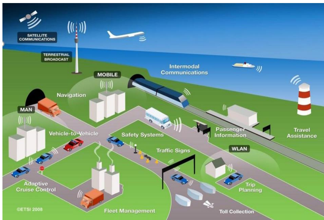
Kuvio 1. Liikennejärjestelmään kytkeytyvät nykyään paikannusjärjestelmät, turvallisuusjärjestelmät, erilaiset matkustajien ja operaattoreiden palvelujärjestelmät, kalustojen hallinta, tiedonvälitysjärjestelmät, liikenteenohjausjärjestelmät, maksujärjestelmät, sekä liikennemuotoja toisiinsa kytkevät järjestelmät (ETSI1 päiväämätön); tämän lisäksi tulevat ihmisten ja laitteiden IoT (Internet of Things), jotka kytkeytyvät niin ikään liikennejärjestelmään, sekä uusien käyttövoimien jakeluinfrastruktuurit (esim. sähkö).
