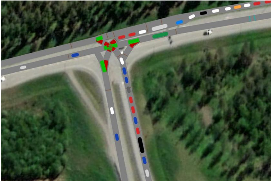
Kuva 3: VISSIM-mikrosimulaatio ramppitasoliittymästä Lohjalla (kansikuva on samasta liittymästä).
