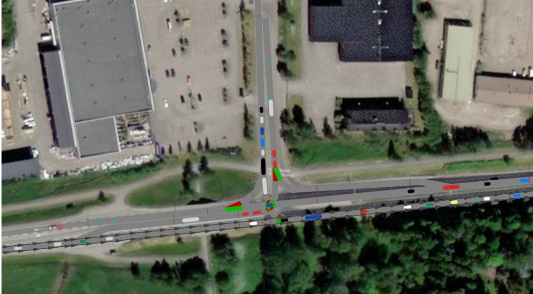
Kuva 11. Kolmihaaraliittymän VISSIM-simulaatio käynnissä.
