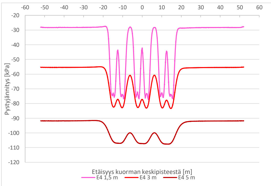
Kuvaaja 26. Normaalijännitys laatan pinnalla kuormakaaviolla E4 eri pengerkorkeuksilla.
