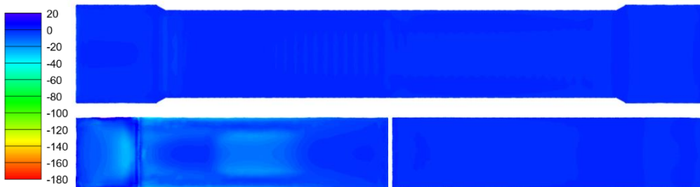
Kuva 54. SL3 – Junakuorman pystykomponentista aiheutuva normaalijännitys [kPa] sillan (yllä) ja paalulaattojen (alla) yläpinnassa.
