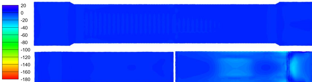
Kuva 55. SL4 – Junakuorman pystykomponentista aiheutuva normaalijännitys [kPa] sillan (yllä) ja paalulaattojen (alla) yläpinnassa.
