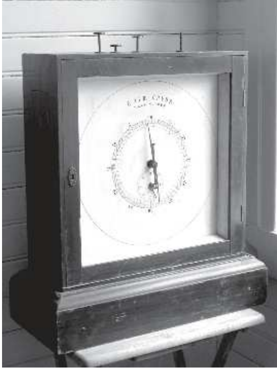
Kellomestari Grubbin laitteella saatiin ajat samanaikaisesti kahdelle kilpailijalle. Kellotaulujakin siinä oli kaksi, etu- ja takapuolella. – Hämeenlinnan kaupungin historiallinen museo.
