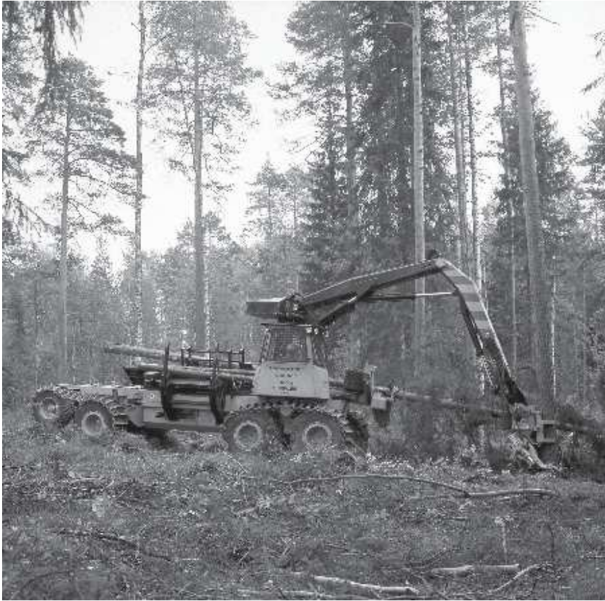
Metsätyökoneet ovat olleet eräs Suomelle tyypillinen koneteollisuuden vientiala. Rautama-Repola Oy:n Lokomon tehtaan valmistama monitoimikone Harvesteri, joka kaa- taa, karsii, katkoo ja kasaa puut. Kuva arvatenkin vuodelta 1975. Metso-Minerals ja Emil Aaltosen museo, Tampere.
