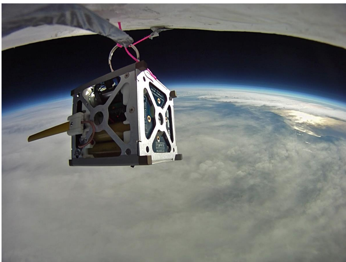
Kuva 73: Ilmapallon kannattama tietoliikennekeskus stratosfäärissä. Stratoliitit ovat "köyhän miehen satelliitteja" ja niitä voidaan varustaa esimerkiksi tietoliikenneyhteyksiä tai valvontatehtäviä varten.
