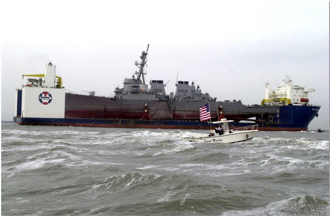
Kuva 57: Ohjushävittäjä USS Cole matkalla korjattavaksi. Laivan kyljessä räjähtänyt 200–300 kiloa räjähdysainetta repi kymmenmetrisen aukon ja tappoi 17 ja haavoitti 39-ää yhdysvaltalaista merisotilasta.
