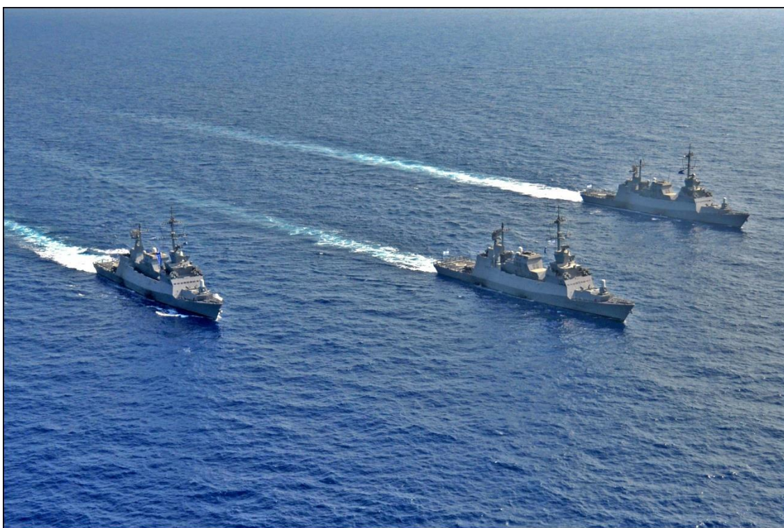
Kuva 52: Sa'ar 5 -luokan korvetit tulivat palveluskäyttöön 1990-luvun alkupuolella. Todellisina monitoimikorvetteina ne kykenevät sukellusveneentorjuntaan, pintasodankäyntiin, ilmapuolustustehtäviin sekä elektroniseen sodankäyntiin.
