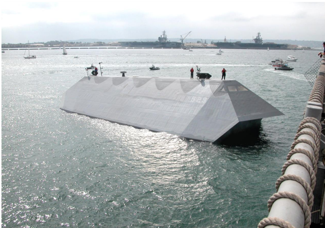
Kuva 76: Aluksen muotoilulla ja sen pintamateriaalilla voidaan yrittää pienentää sen havaittavuutta tutkalla. Kuvassa Yhdysvaltain laivaston koealus "Sea Shadow".
