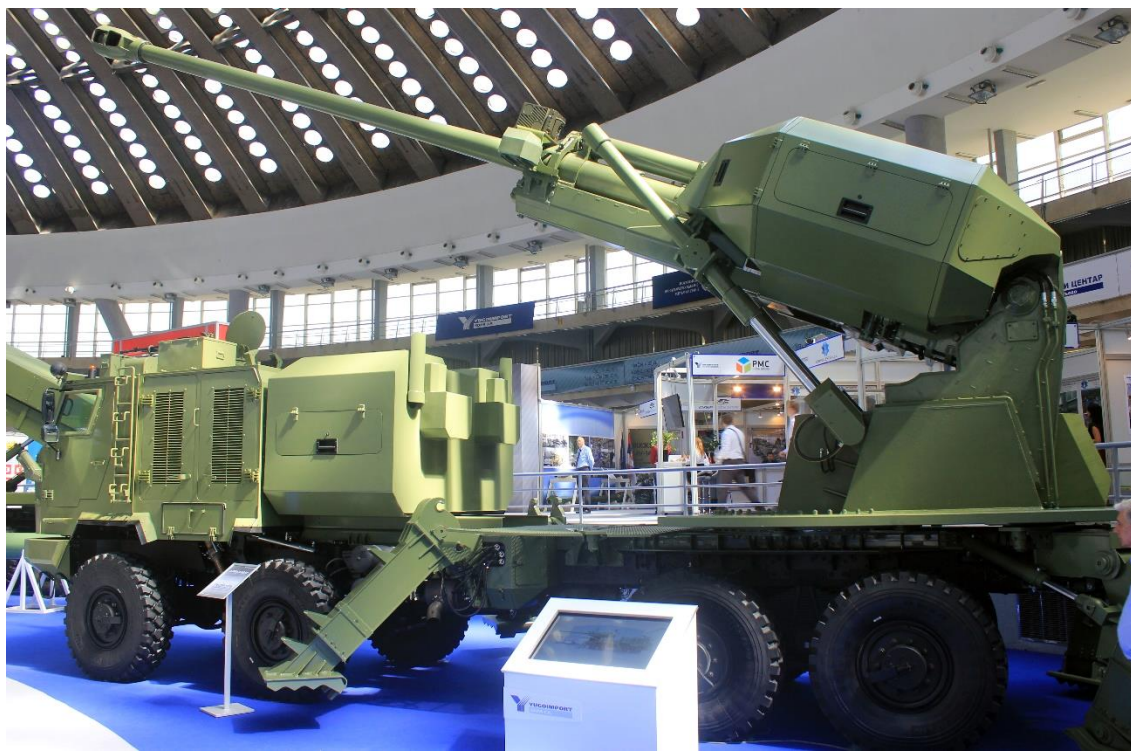
Kuva 74: Useimmissa nykyaikaisissa tykistöjärjestelmissä on liikemaaliammuntakyky. Kuvan Yugoimportin tykistöjärjestelmän kantama on yli 30 kilometriä, perävirtauskranaatilla yli 50 kilometriä ja kranaatin kehitysversiolla yli 60 kilometriä.
