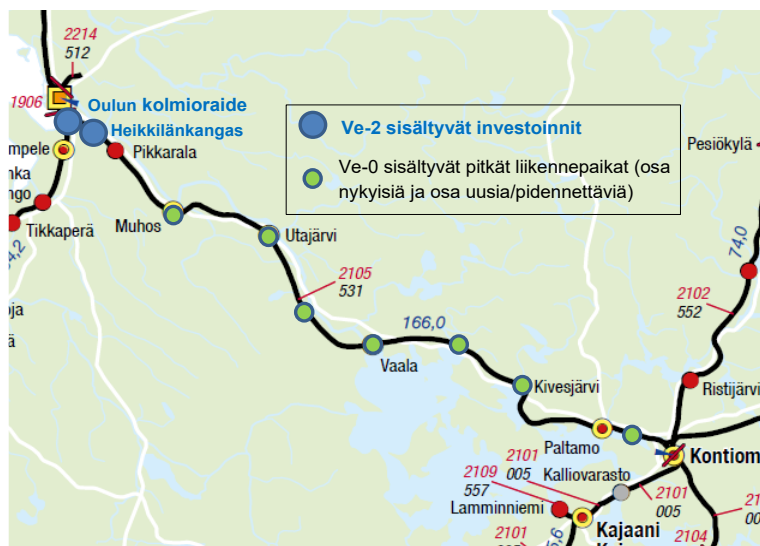
Kuva 2. Hankevaihtoehtoon 2 sisältyvä Oulun kolmioraide ja Heikkilänkankaan liikennepaikka (kuvassa on myös vertailuvaihtoehtoon (Ve-0) sisältyvät uudet ja pidennettävät liikennepaikat).
