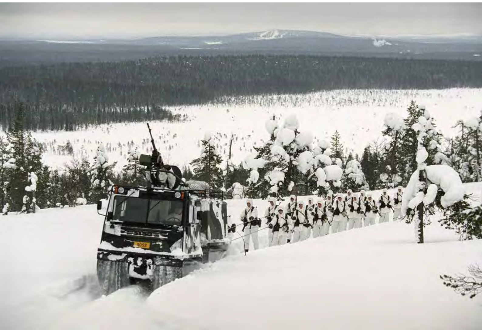
■ Pohjois-Suomen joukoille hankittiin kotimaisia telakuorma-autoja, joita voitiin käyttää myös hiihtohinaukseen. Kuva: Matti Kaltokari / Puolustusvoimat, Sotamuseo.
