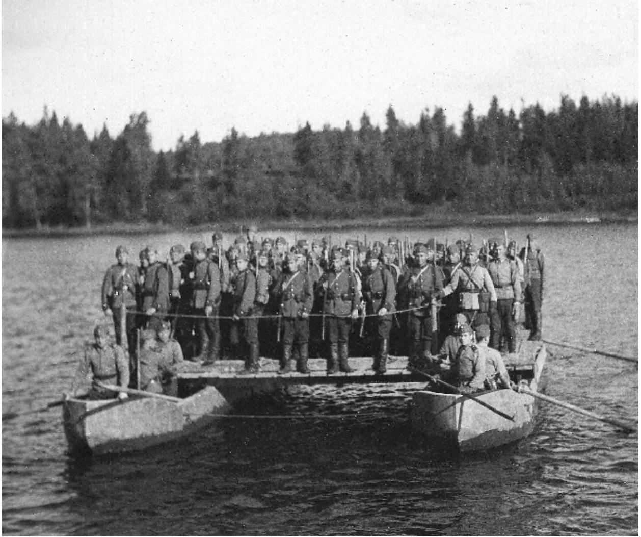
Vesistön ylimenokalustona testattiin ponttoonilauttaa m/25. Joukkojen ylikuljetusta 1920- ja 1930-lukujen vaihteesta. Kuva: Sotamuseo
