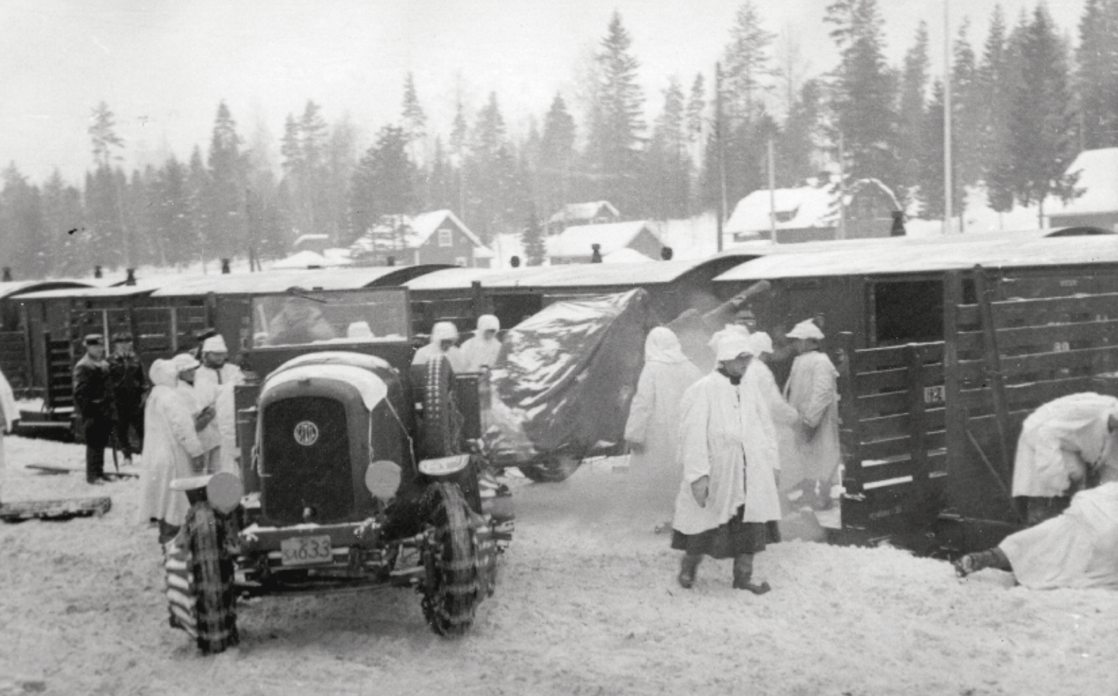
Ilmatorjunnan käyttöön hankittiin ranskalaisia Latil-traktoreita. Traktoria ja sen vetämää kenttätykkiä puretaan junakuljetuksesta talvisotaharjoituksissa Laatokan Karjalassa vuonna 1937. Kuva: Sotamuseo
