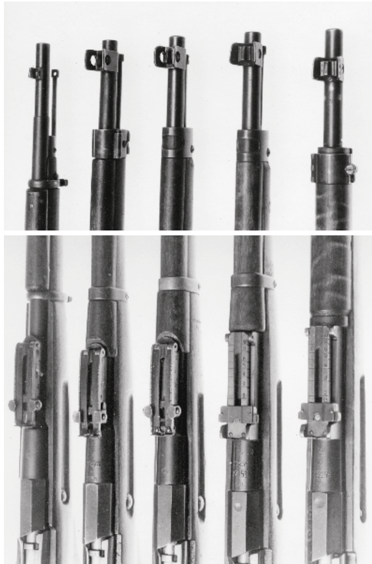
Suomalaisten sotilaskiväärimallien kehitys ja selvimmät erot maailmansotien välisenä aikana näkyvät selvimmin etu- (ylh) ja takatähtäimistä sekä myös tukin siderenkaista. Vasemmalta kiväärit m/24, m/27, m/28, m/28-30 ja m/39. Kuva: Sotamuseo
