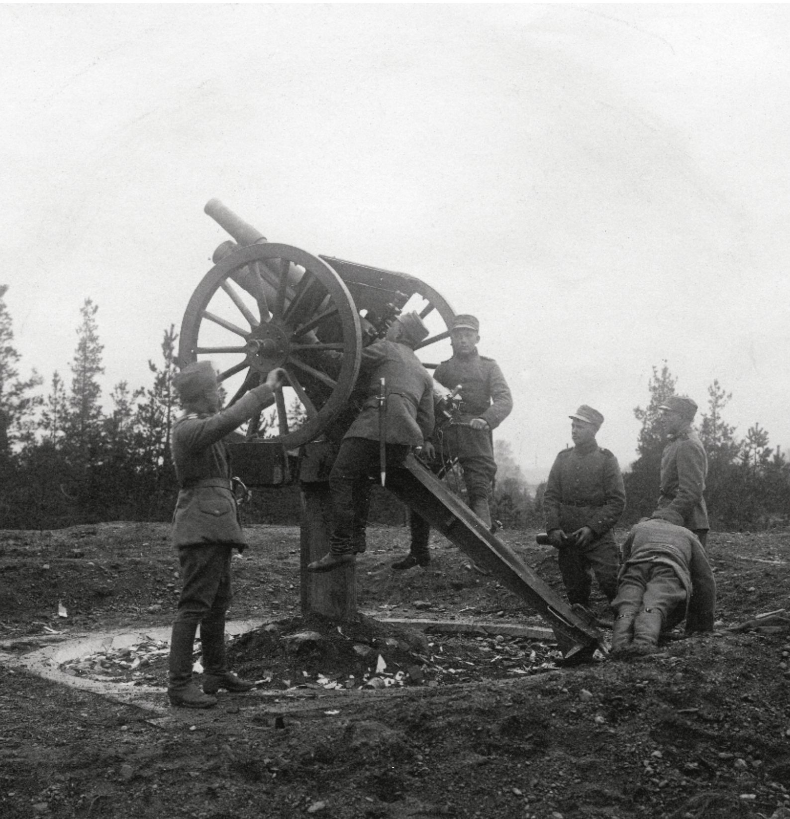
Kenttätykkistön erikoisimpia kokeiluita: kenttätykki 76 K/02 ilma-aseena. Kuva: Sotamuseo
