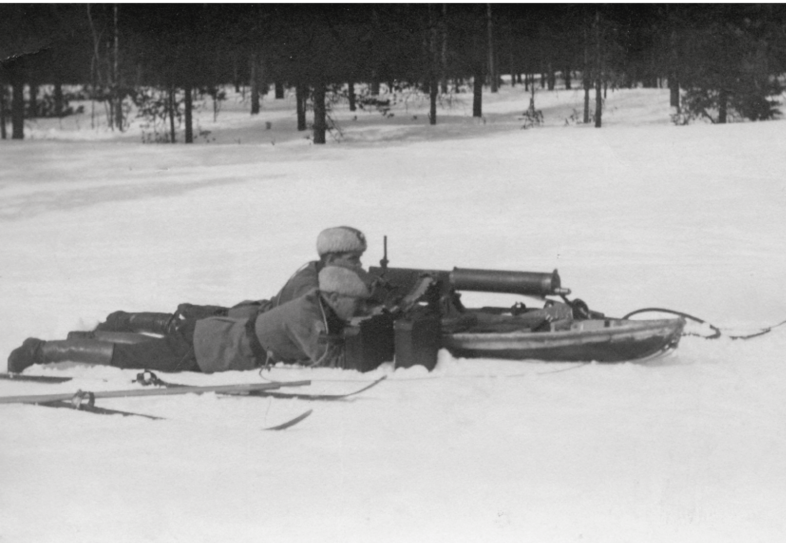
Konekiväärille suunnitellusta ahkiosta piti pystyä myös ampumaan. Kuva: Sotamuseo
