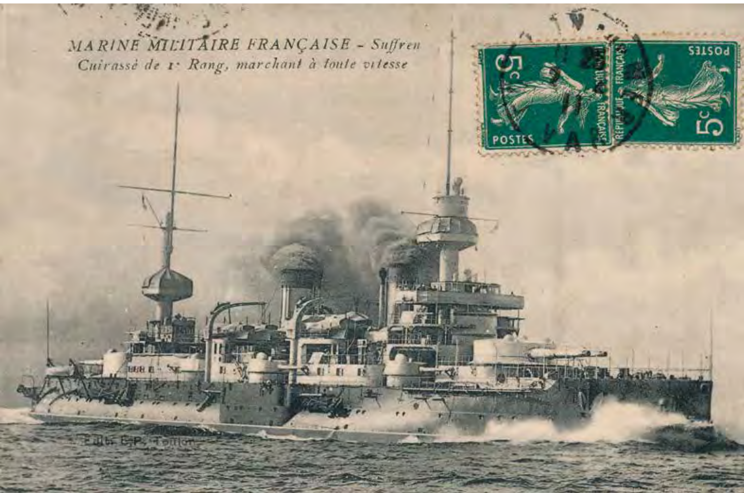
KUVA 47 • Suffrenin toissijainen tykistö oli poikkeuksellisesti kasemattien lisäksi osin omissa tykkitorneissaan, Ranska vuonna 1904.
