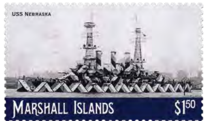
KUVA 20 • Pre-dreadnought Nebraskan ristikkomastot ja harhautusväri 1. MS:n aikana, Yhdysvallat vuonna 1907.
