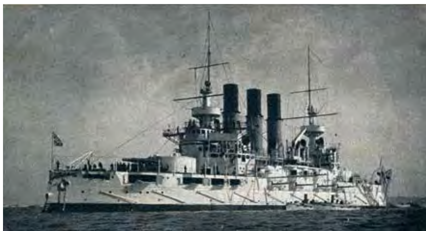
KUVA 30 • Venäjän pre-dreadnought Retvizan valmistui Philadelphiassa Yhdysvalloissa. Ram-keulassa näkyy tuon aikakauden tyyppilinen torpedoputken suuaukko. Yhdysvallat vuonna 1902.
