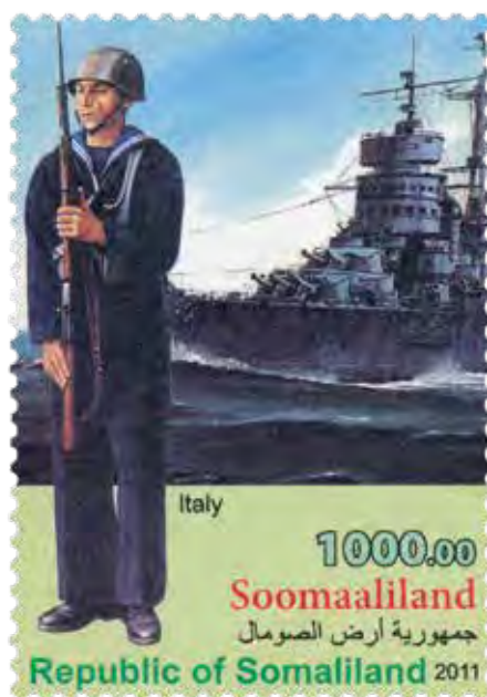
KUVA 184 • Cavour-luokan dreadnought Giulio Cesare muutettuna noin 30 000 tonnin ja 27 solmun taistelulaivaksi, Italia vuonna 1914 muutos 1930-luvulla.
