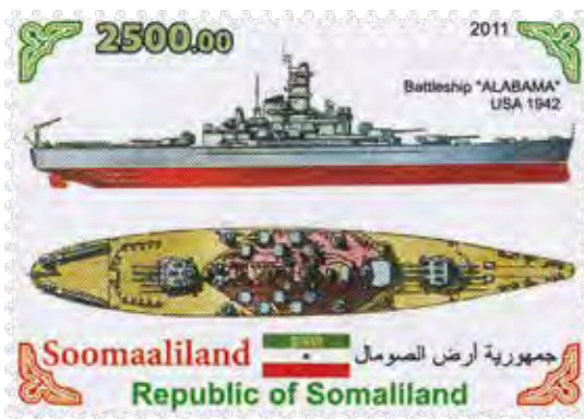
KUVA 195 • South Dakota-luokan taistelulaiva Alabama, peräkannella kaksi katapulttia ja vain yksi savupiippu, Yhdysvallat vuonna 1942.
