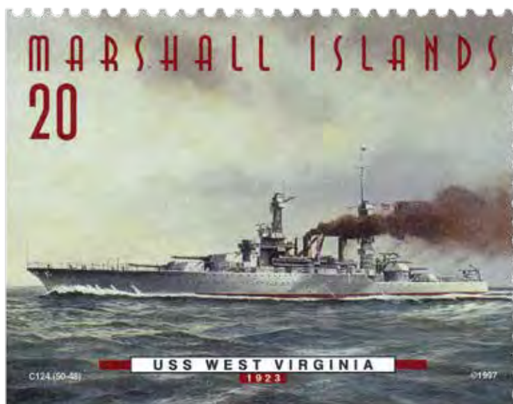
KUVA 141 • Colorado-luokan alukset olivat viimeiset Yhdysvalloissa valmistunut super-dreadnoughtit, kuten West Virginia, mutta ensimmäiset 406 mm (16") tykistöillä varustetut, ristikkomastot ovat hieman madaltuneet, Yhdysvallat vuonna 1923.
