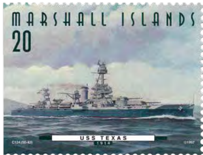
KUVA 166 • Yhdysvaltojen ensimmäinen super-dreadnought New York -luokan Texas, ristikkomastot poistettiin 1920-luvun modernisoinnin yhteydessä, tilalle tuli brittiläistyyppiset kolmijalkamastot, Yhdysvallat vuonna 1914.
