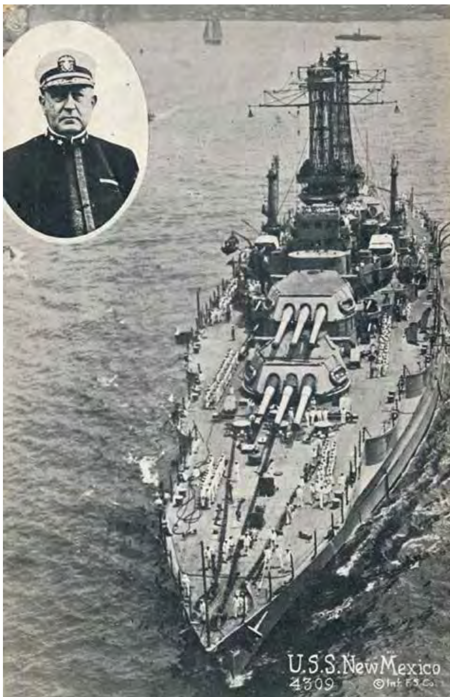
KUVA 139 • Yhdysvaltojen New Mexico-luokka oli ensimmäinen klipperi-keulainen ja neljällä kolmiputkisella tykkitornilla aseistettu super-dreadnought, Yhdysvallat vuonna 1918.
