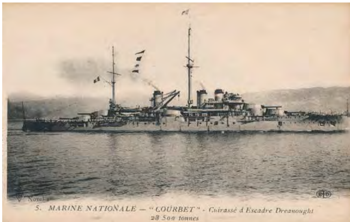
KUVA 96 • Ranskan ensimmäinen Courbet-luokan dreadnought Courbet, keskilaivassa näkyy tykkitorni vielä vanhakantaisesti WP-asemassa, Ranska vuonna 1913.
