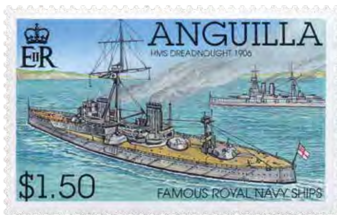
KUVA 86 • Dreadnoughtin korkean maston raa'at oli tarkoitettu erilaisille viesti- ja päällikköslippuille sekä radioantenneille, savut haittasivat maston tulenjohtoaseman toimintaa, tykistön laatu ja asettelu käy hyvin selville, taustalla on pre-dreadnought King Edward VII, Britannia vuonna 1906 ja 1905 (King Edward VII).
