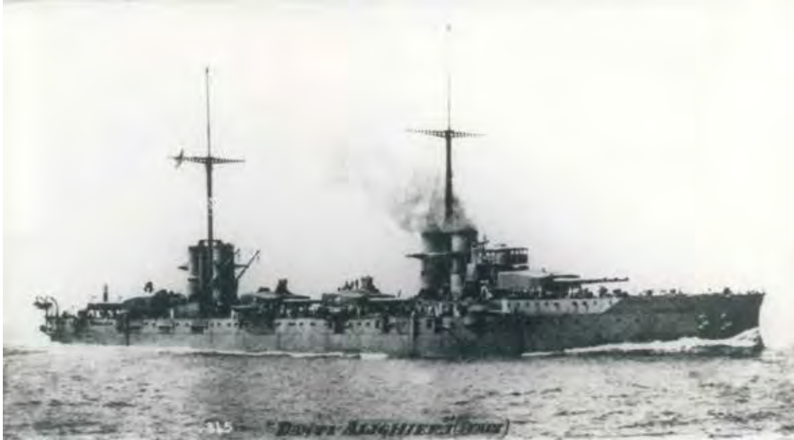
KUVA 100 • Italian ensimmäinen dreadnought Dante Alighieri ja maailman ensimmäiset kolmiputkiset tykkitornit, Italia vuonna 1913.
