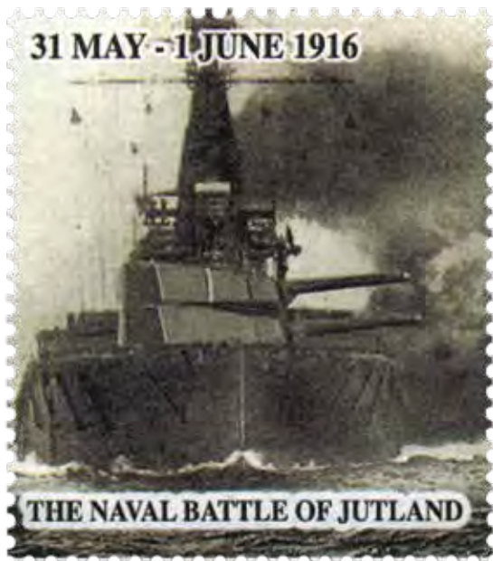
KUVA 121 • Super-dreadnought Thundererin 2x2 343 mm/45 tykit SFB-asetelmassa ampuvat täyslaidallista Skagerrakin meritaistelussa, kyljessä näkyy vielä torpedonestojärjestelmän puomeja, Britannia vuonna 1912.
