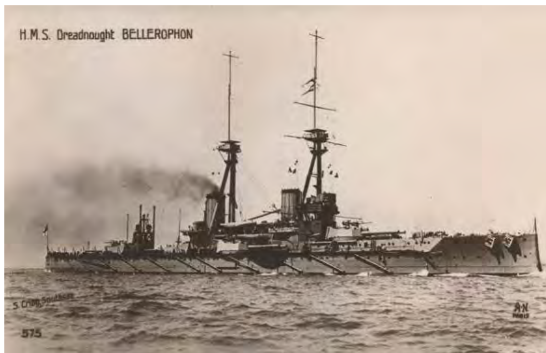
KUVA 87 • Bellerophonilla oli kaksi isoa kolmijalkamastoa Dreadnoughtin yhden sijaan, Britannia vuonna 1909.
