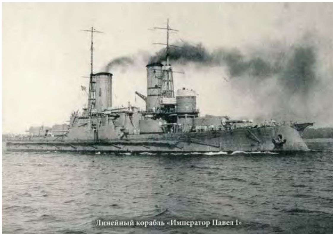
KUVA 77 • Venäjän semi-dreadnought Imperator Pavel I, lyhennetyt ristikkomastot, torpedoestoverkot ylhäällä, Venäjä vuonna 1911.
