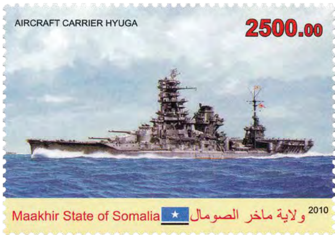
KUVA 179 • Ise-luokan super-dreadnought Hyuga muutettuna hybriditaistelualukseksi (yhdistetty tykistö- ja lentotukialus), perä on muutettu lyhyeksi lentokannekseksi, Japani vuonna 1917–1918.
