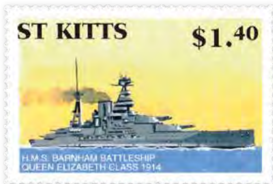
KUVA 129 • Britannian super-dreadnought Barham (kuvassa nimi on väärin), modernisoinnissa asennettu torpedosuoja vesirajassa ja yhdistetty savupiippu, kyljen 6 x 152 mm kasemattitykeistä taaimaiset poistettiin myöhemmin, Britannia vuonna 1915.
