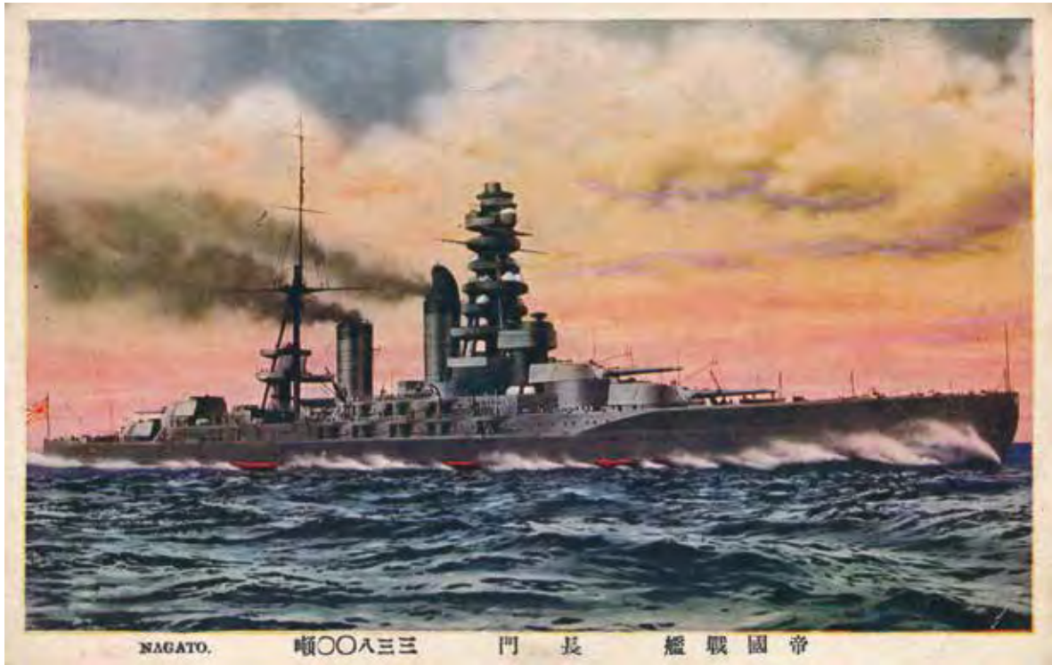
KUVA 148 • Maailmansodan aikana Japanissa viimeinen aloitettu super-dreadnought-luokka, Nagato sai ensimmäisenä maailmassa 406 mm (16") tykistön, seitsemänjalkainen masto, Japani vuonna 1920.
