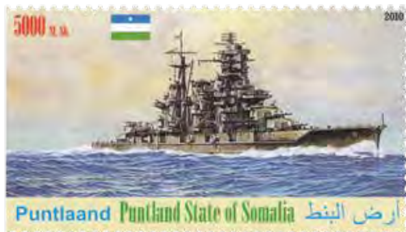
KUVA 181 • Kongō-luokan taisteluristeilijät muutettuna noin 36 000 tonnin ja 30,5 solmun taistelulaivoiksi, Japani vuonna 1915 muutos 1930-luvun alussa.
