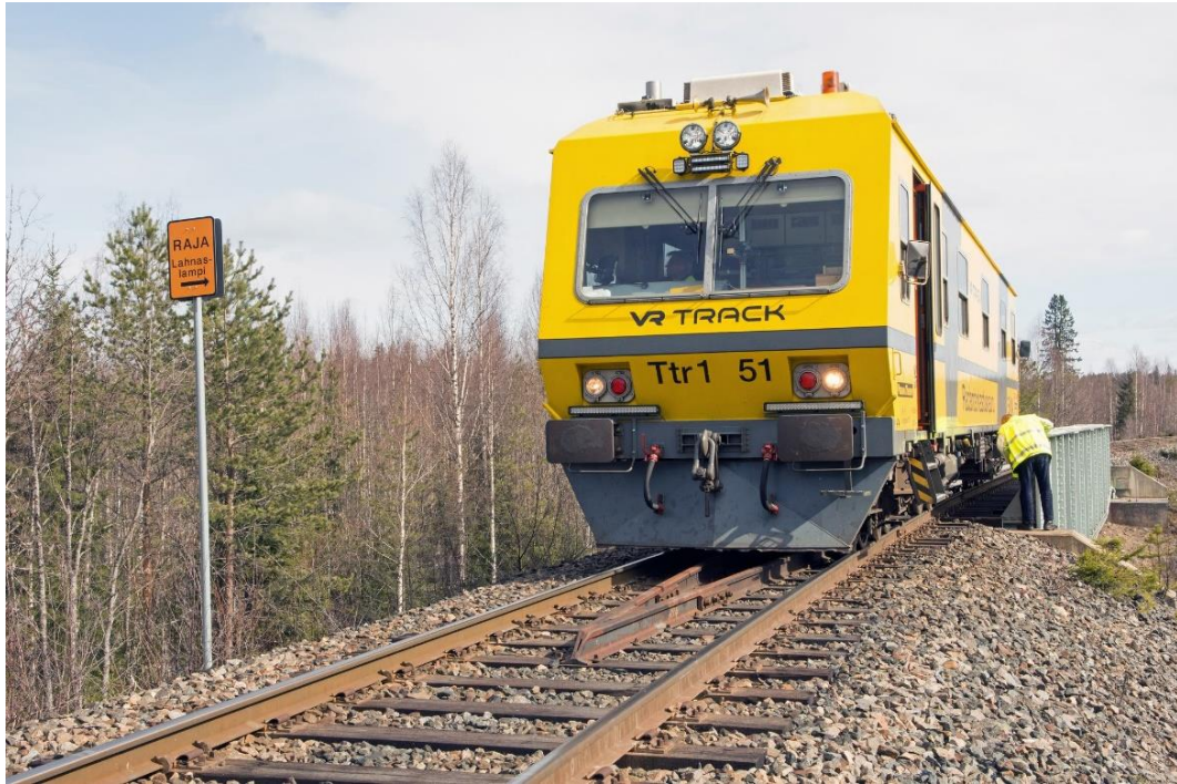
Kuva 73. EMMA-radantarkastusvaunu Lahnaslammella valtion rataverkon ja yksityisen rataverkon rajalla 7.5.2017.
