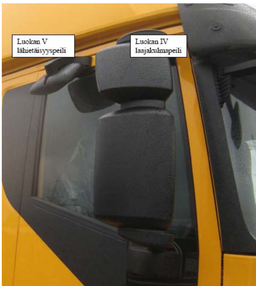
Kuva 13. Esimerkki kuorma-auton A-pilarin ja taustapeilien muotoilusta.
