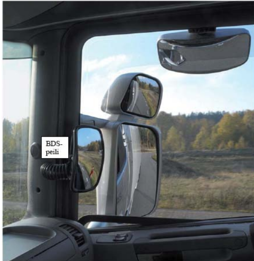
Kuva 12. Esimerkki mahdollisesta nykyaikaisesta kuorma-auton peilikonstruktiosta (AKE 2008).
