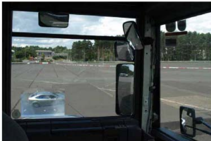
Kuva 15. Esimerkki Fresnel-linssin mahdollisuuksista tilanteessa, jossa henkilöauto ei ole nähtävissä muista ajoneuvon peleistä (5 kappaletta) - henkilöauto sijaitsee oikealta ajettavan kuorma-auton vieressä. Kuva on toki äärimmäinen esimerkki ja se pääasiallinen tavoite on kuvata Fresnel-linssin toimintaa (Dodd 2009).
