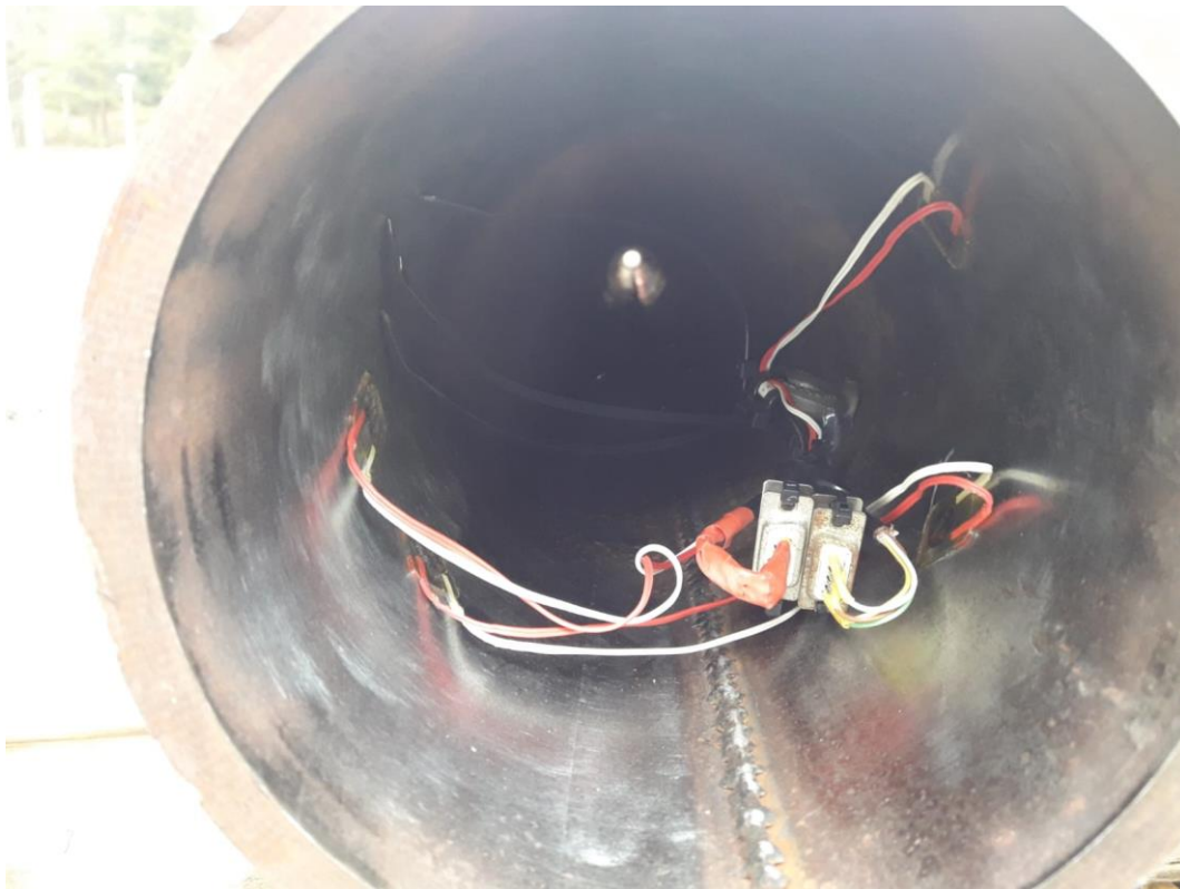
Kuva 4. Ristiliuskat liimattuna putken sisäpuolelle kärjen tuntumaan.
