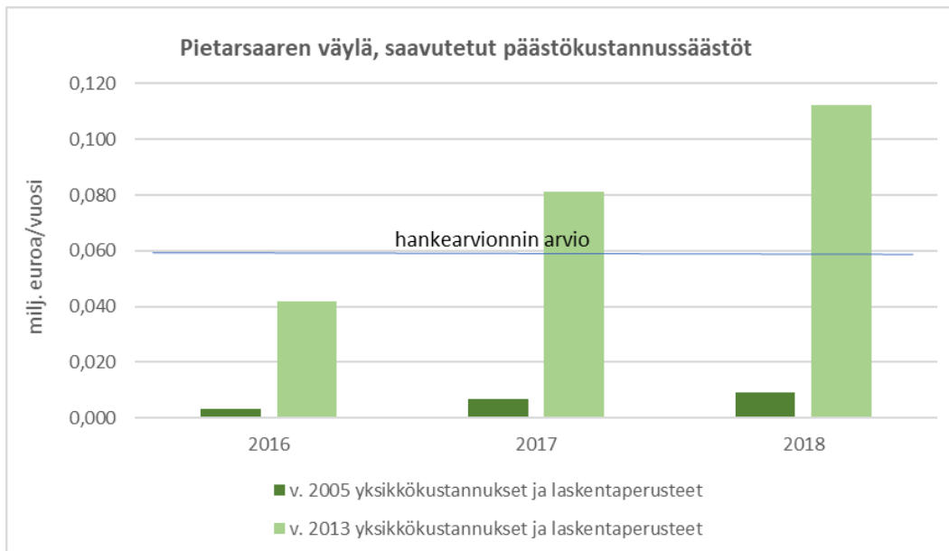
Kuva 49. Pietarsaaren meriväylän syventämisellä saavutetut päästökustannussäästöt vuosien 2005 ja 2013 hiilidioksidipäästöjen yksikkökustannuksilla laskentaperusteilla sekä hankearvioinnin arvio säästöistä.
