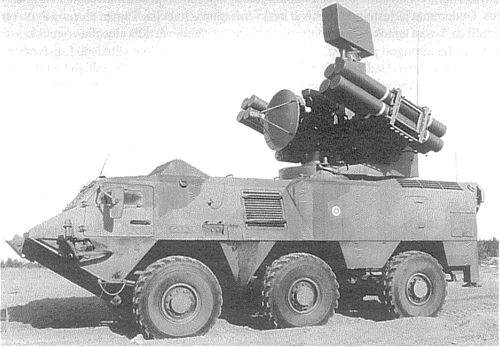
Kuva 226 Automaattisen komento-ohjauksen periaatteella toimiva Crotale kohdetorjuntaohjusjärjestelmä
