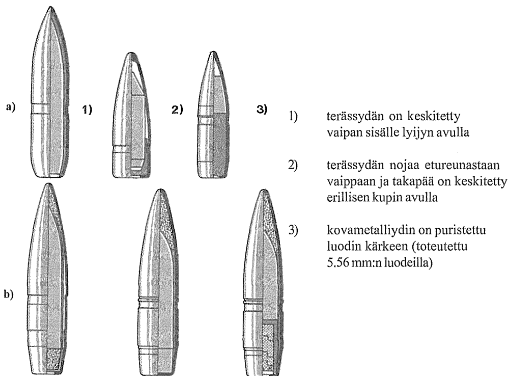
Kuva 124 Panssariluoteja (a) ja panssarisytytysluoteja (b)
