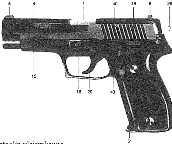
Kuva 78 Pistoolin yleisrakenne 1. piippu, 4. luisti, 5. etutähtäin, 6. takatähtäin, 15. runko, 16. piipun lukitussalpa, 18. luistin salpa, 20. liipaisin, 29. iskuvasara, 40. virevapautin, 43. lippaan salpa, 51. lipas
