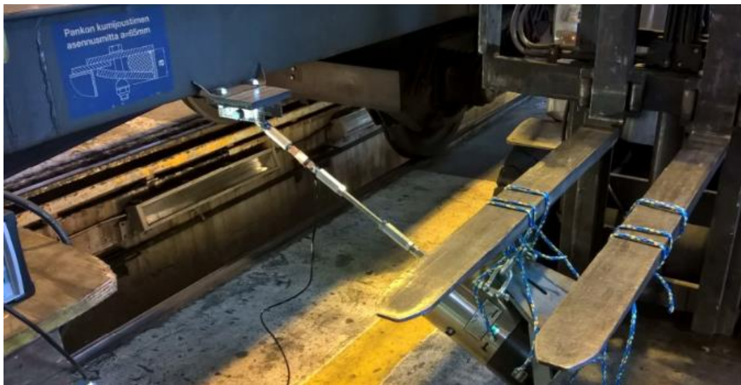
Kuva 6.10 Sähköinen täristin varressaan voima-anturi. Täristin kiinnitettiin trukin sarviin ja se oli liitetty vaunun pankon kumijoustimen kiinnitysreikään.
