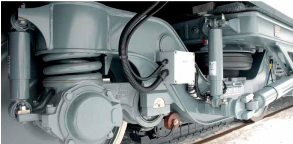
Kuva 5.2 Kaksikerroksisen matkustajavaunun TB201-teli. Ilmajousi näkyy telin keskikohdassa tummanharmaana ja anti-yaw-vaimennin radansuuntaisena telin ulkoreunalla. (Transtech 2015)
