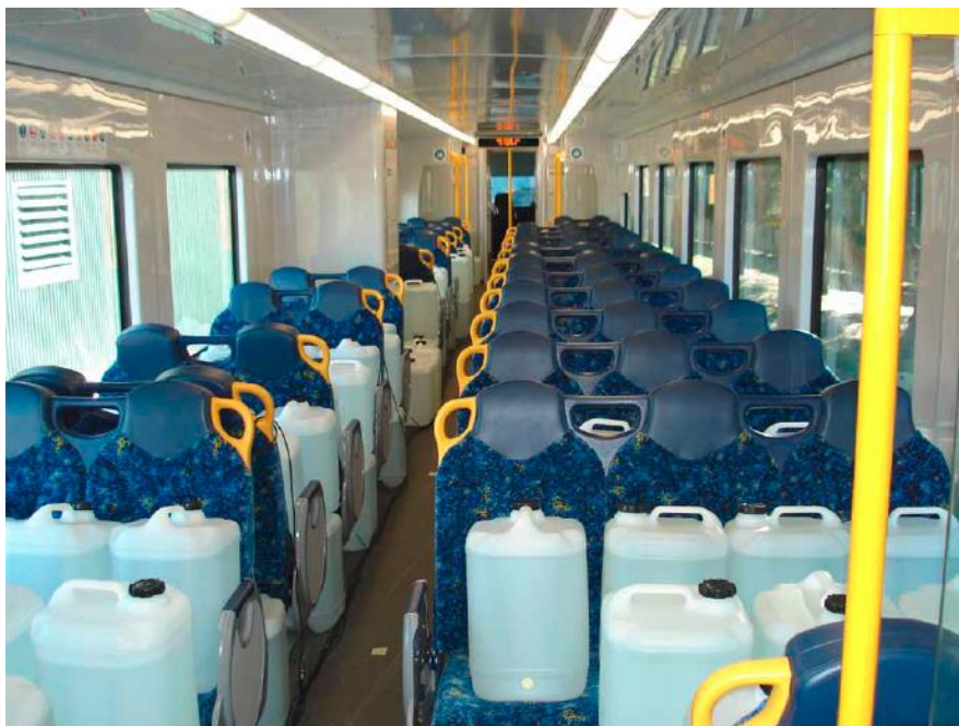
Kuva 4.6 Vesisäiliöillä tehty kuormitus ajonaikaisessa moodianalyysissä (Hanson et al. 2008).
